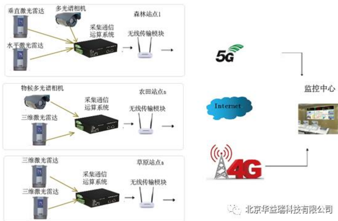
图 8 EcoLidar 设备观测流程及数据传输过程
