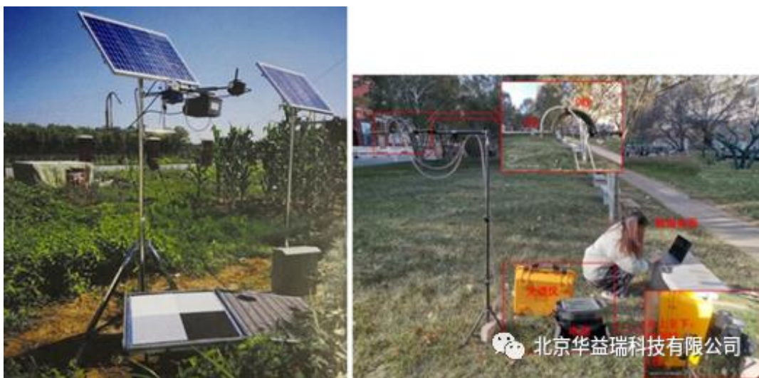
图 6 SpecNet 设备组成及观测场景
