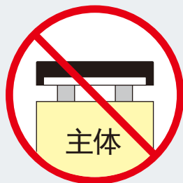
主体悬空安装
