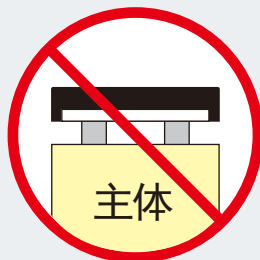
主体悬空安装
