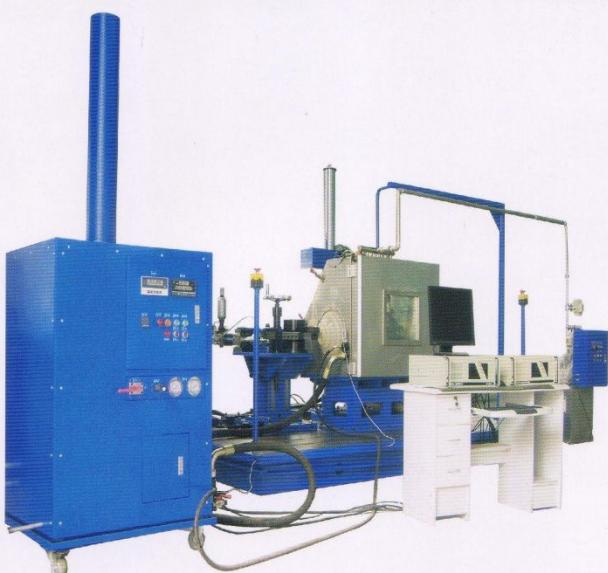
测量控制系统由主控模板，位移测量控制模板，负荷测量控制模板，高精度函数发生器模板及工控机箱。总线采用ISA总线，可以实现试验数据高速采集，控制命令快速传输。控制方式采用数字调节模拟控制技术，既有数字控制优点，又有模拟控制的宽范围的响应。
