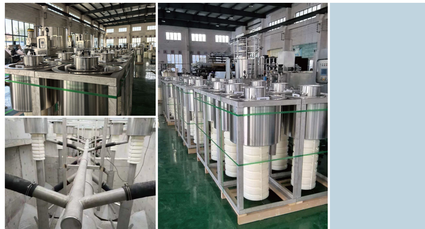
湖南某污水处理厂 15万吨 活性砂滤池
