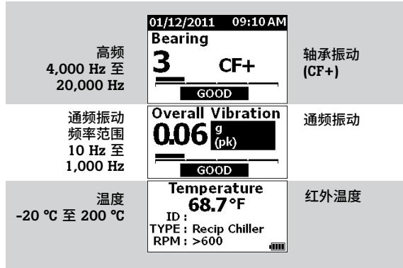
样品测量结果屏幕，指示了轴承和通频振动的四种严重等级 (Good (良好)、Satisfactory (一般)、Unsatisfactory (不符合要求)、Unacceptable (不可接受))
