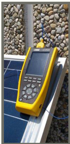
太阳能电池板的温度测量。 磁化多功能配件灵活实用，无需手动操作。
