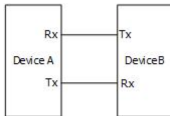
图 18.4 RS232 串行总线示意图
