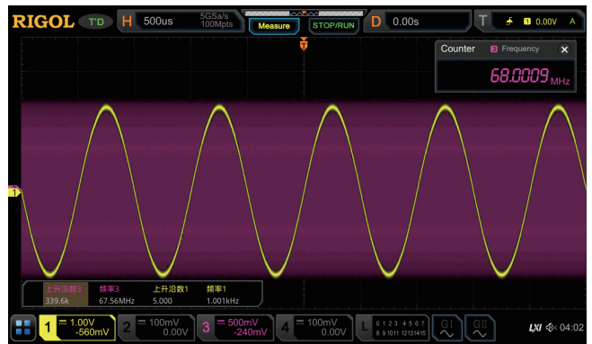
同时观察并准确测量两路频率相差很大的信号，全内存硬件测量可以在具有339.6k个上升沿的波形中测得准确的频率值
