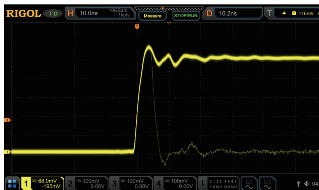
高刷新率模式下捕获偶发异常信号
