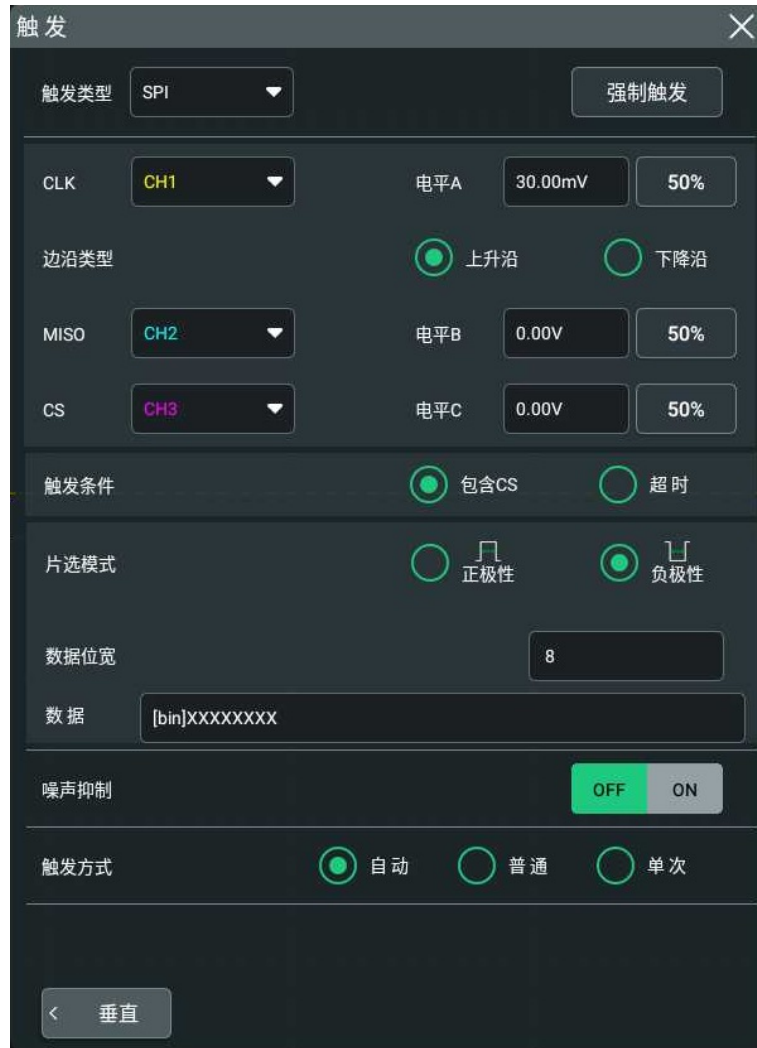
图 8.31 SPI 触发配置菜单
