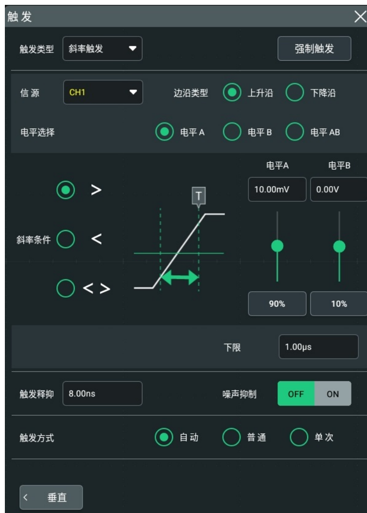
图 8.7 斜率触发配置菜单
