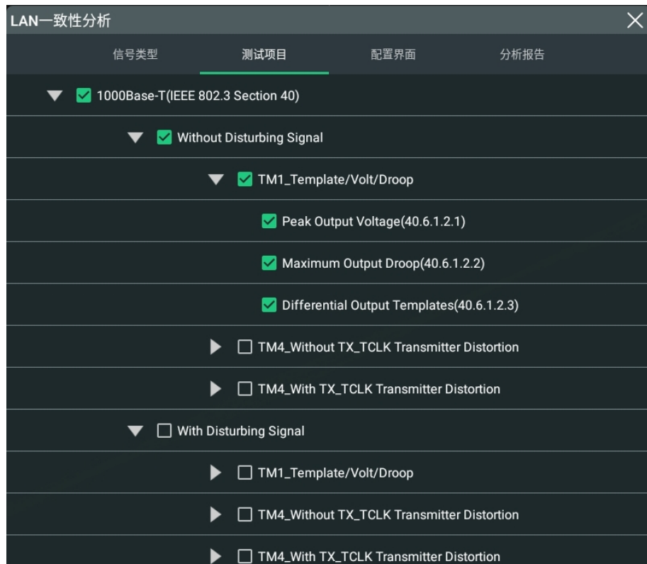
图 19.3 1000Base-T 信号测试项目
