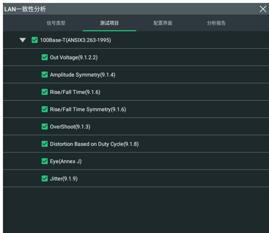
图 19.2 100Base-T 信号测试项目
