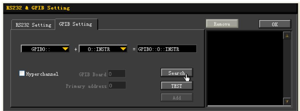
图 2.1 搜索 GPIB 连接设备
