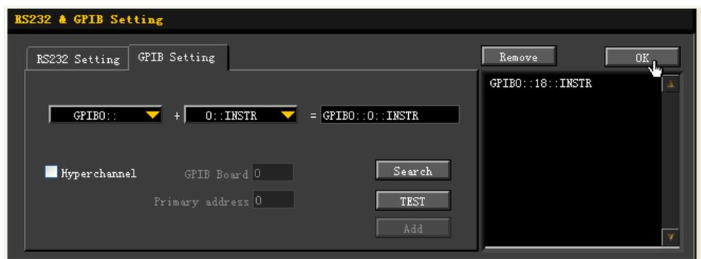
图 2.2 确认 GPIB 连接设备
