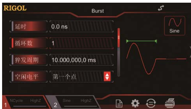
图 2-11 N 循环脉冲串
