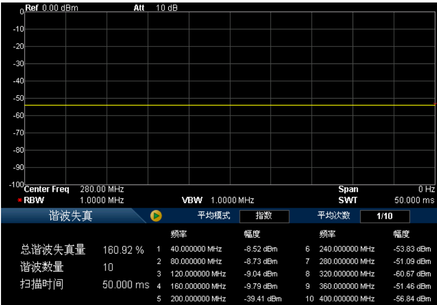
图 2-18 谐波失真测量界面
