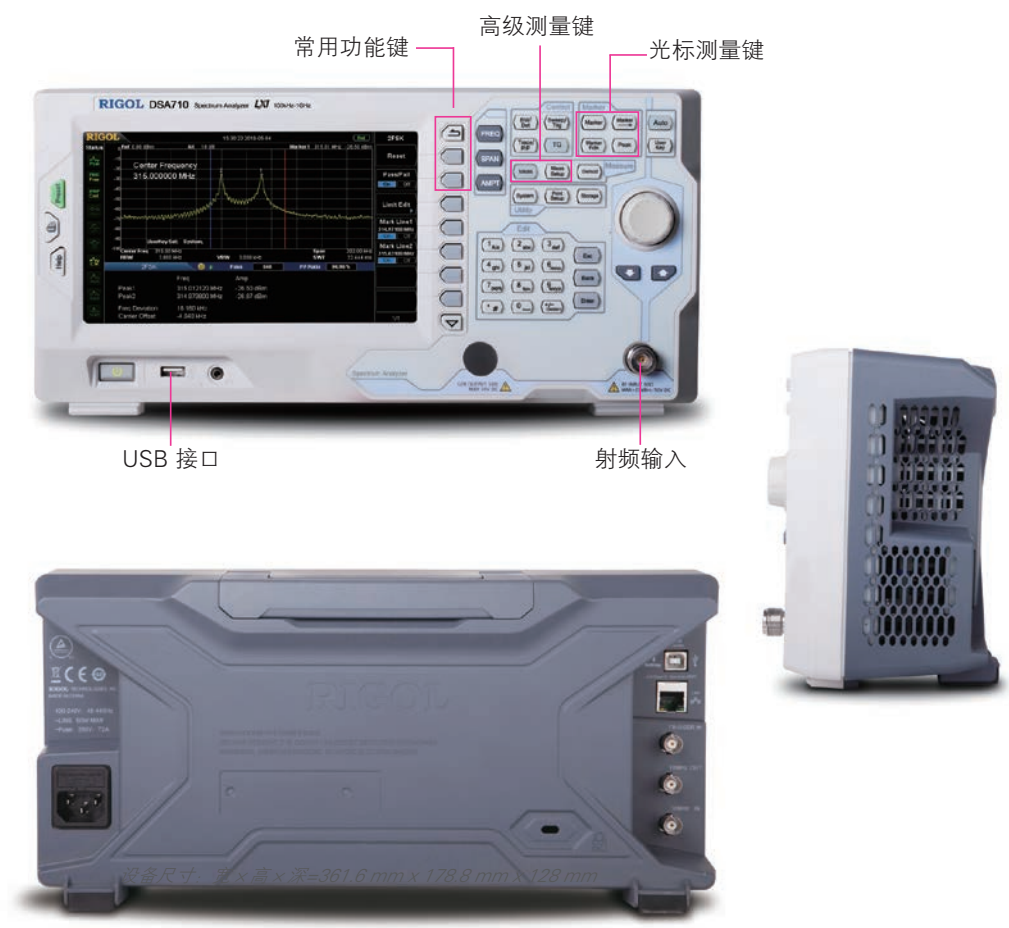
设备尺寸: 宽×高×深=361.6 mm x 178.8 mm x 128 mm
