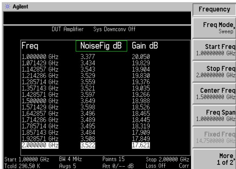
步骤 4. 按 **Format** 键，将 **Format** 菜单键设为 **Graph**（图形）。会显示类似于图 2-29 的图形结果。
