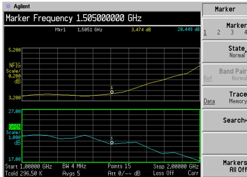
现在有一对耦合标记放置在两条轨迹上。转动 **RPG**，使标记放置在您希望测量的轨迹点上，或者用数字键输入相关频率。标记频率和测量参数在图形上方被批注。频率值在现用功能区中显示。
