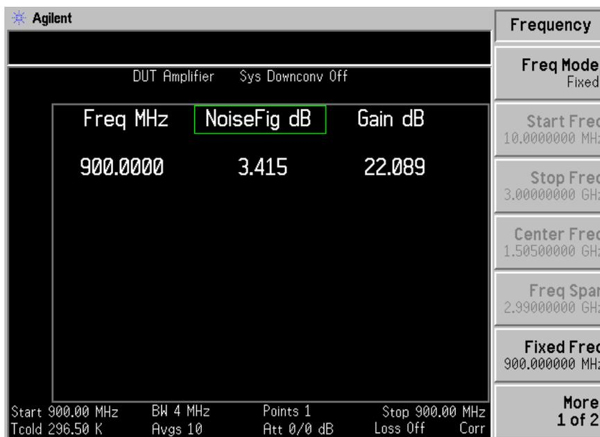
在图 1-7 中显示的结果显示 DUT（被测装置）在 900 MHz 的噪声指数和增益。
