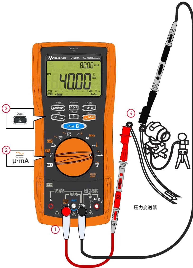
图 2-30 使用 0-20 mA 百分比刻度测量 DC 电流
