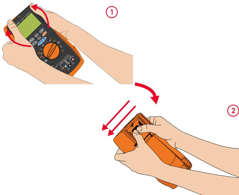
图 1-1 取下橙色橡胶皮套
