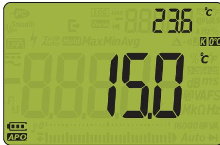
图 2-25 没有环境补偿的温度测量
