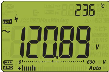
图 2-5 带 LPF 显示的 AC 电压
