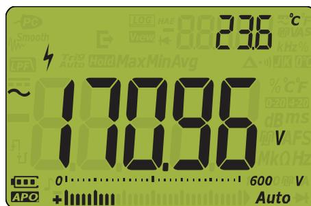
图 2-1 AC 电压显示
