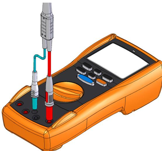
图 1-16 远程开关探针到万用表的连接
