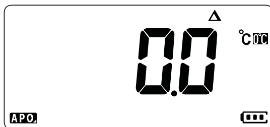
图 2-21 没有环境补偿的温度测量
