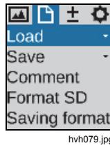
可以使用操纵杆 浏览菜单，使用操纵杆中心按钮 (Enter) 接受设置。菜单上边缘含有四个主菜单，可以通过相应的选项卡符号进行选择：
