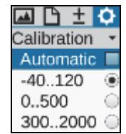
可以根据物体温度和测量任务手动或自动设置具体量程。但是，必须确保当前场景的温度不会超过设定量程，以免红外图像过载。
