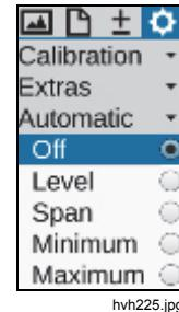
"Automatic" (自动) 菜单项用于选择不同的变量，以使所示温度范围自动适应当前场景。默认激活的自动表示法 ("Off" (关闭)) 可以由以下变量替代：
