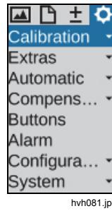
操纵杆 ◆ 在菜单中用于浏览至菜单顶部 ↑ 和/或底部 ↓。主菜单可以使用按钮 ← 和 → 切换。根据 "Menu control" (菜单控制) 功能中 "System" (系统) 菜单项的 "Settings" (设置) 菜单对 "Menu control" (菜单控制) 所选的设置 (请参阅第 3-46 页系统菜单)，任何时候都可以按 ↑ 从顶部直接访问下部菜单，按 ↓ 从底部直接访问上部菜单，按 → 从 "Settings" (设置) 中直接选择 "Image" (图像)，或者按 ← 反之亦然。
