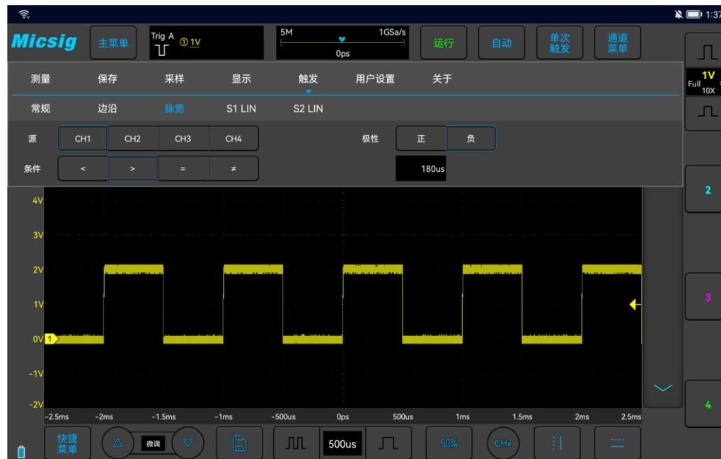
图5-14 负极性脉冲电平翻转
