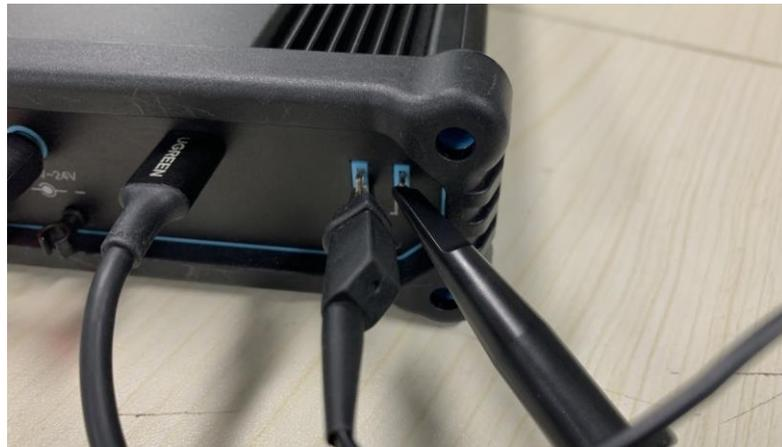
图2-10 探头连接方式
