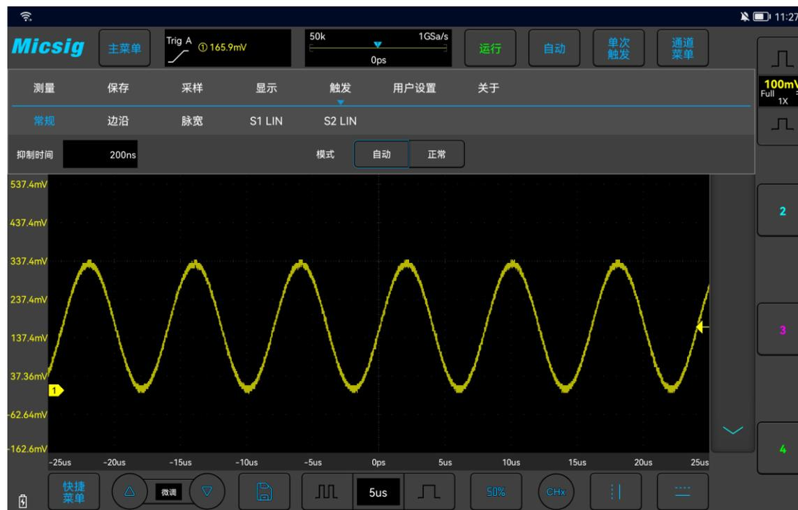
图5-5 示波器触发模式设置
