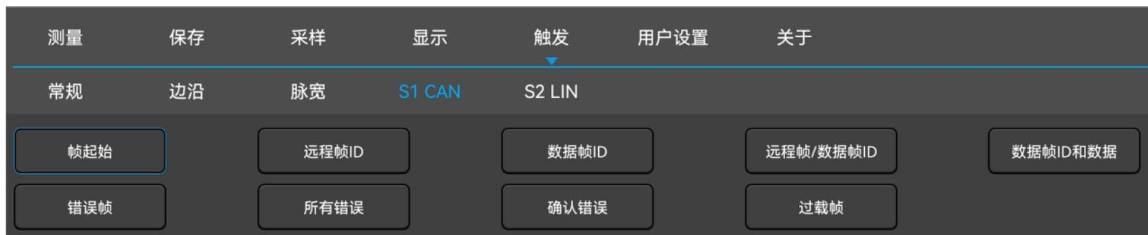
图11-6 CAN 触发方式配置菜单
