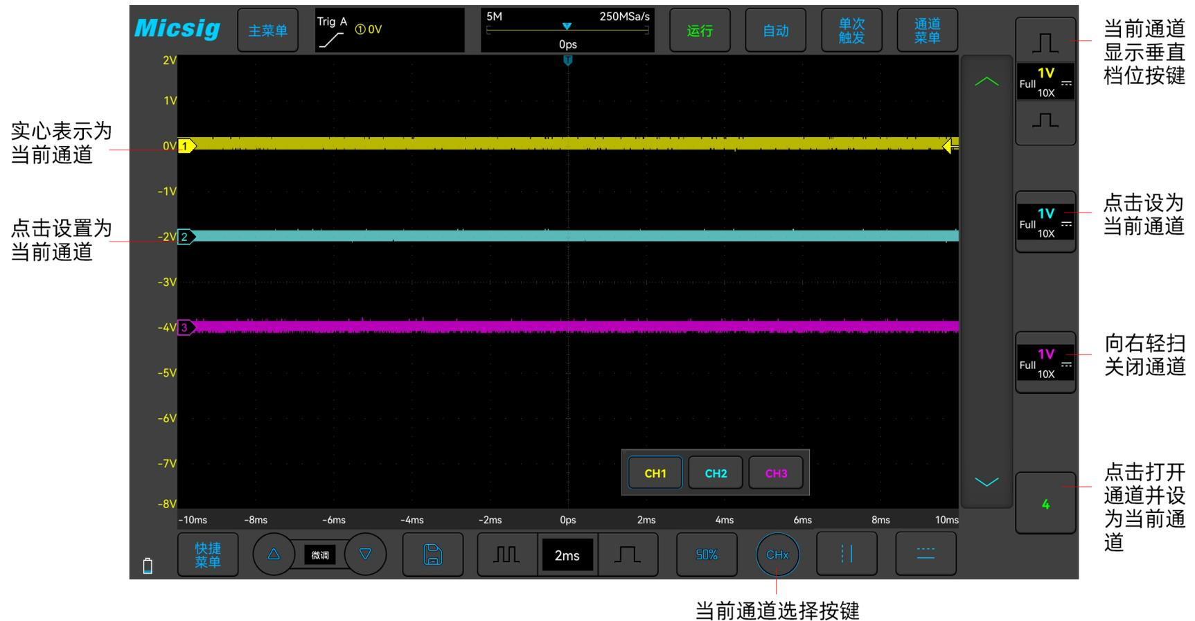
图4-4 通道的打开、关闭与切换
