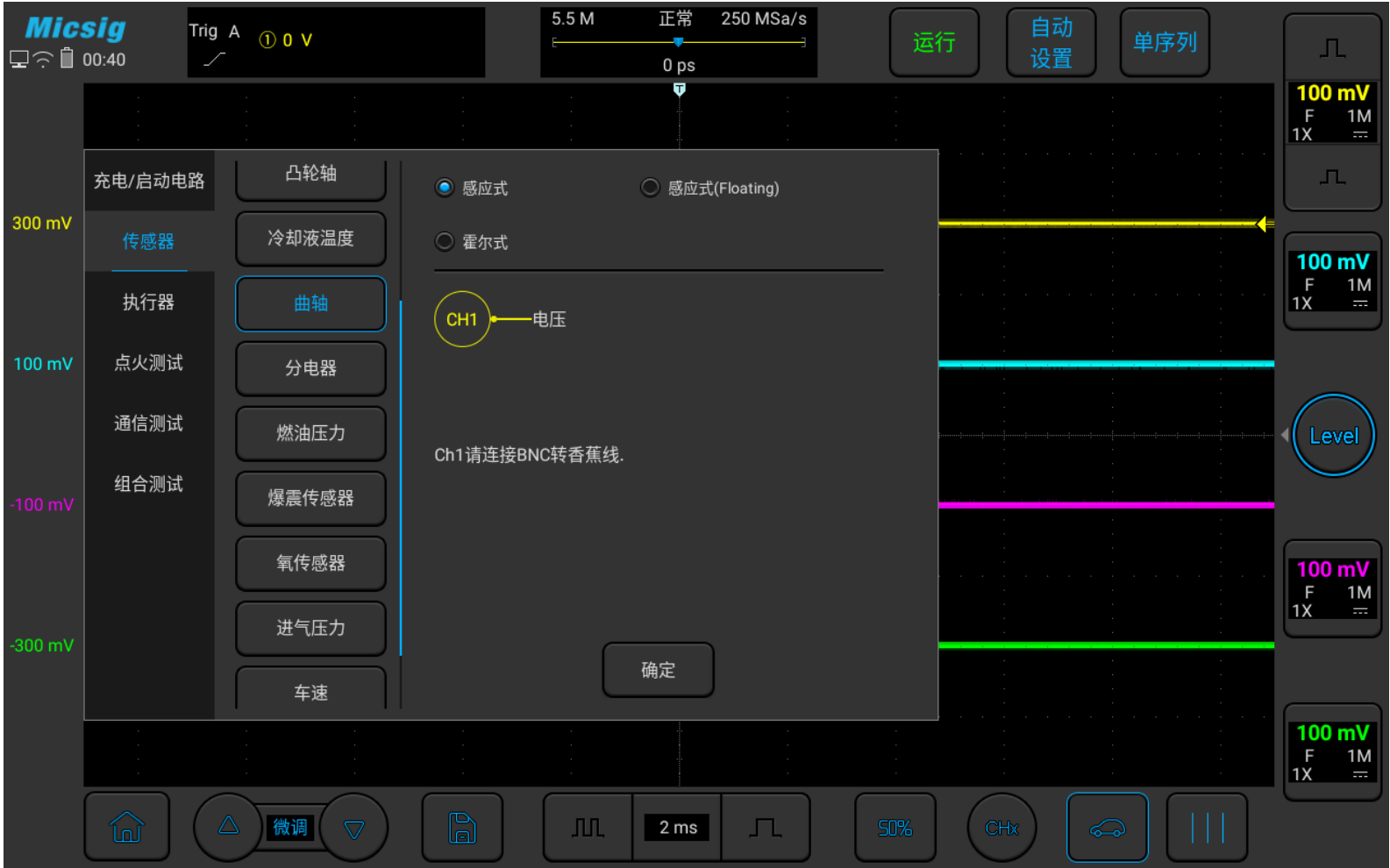
图3-17 曲轴位置传感器测试
