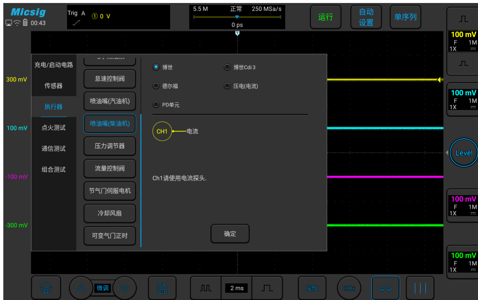
图3-36 喷油嘴（柴油机）测试
