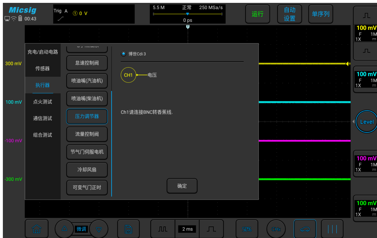
图3-37 压力调节器测试
