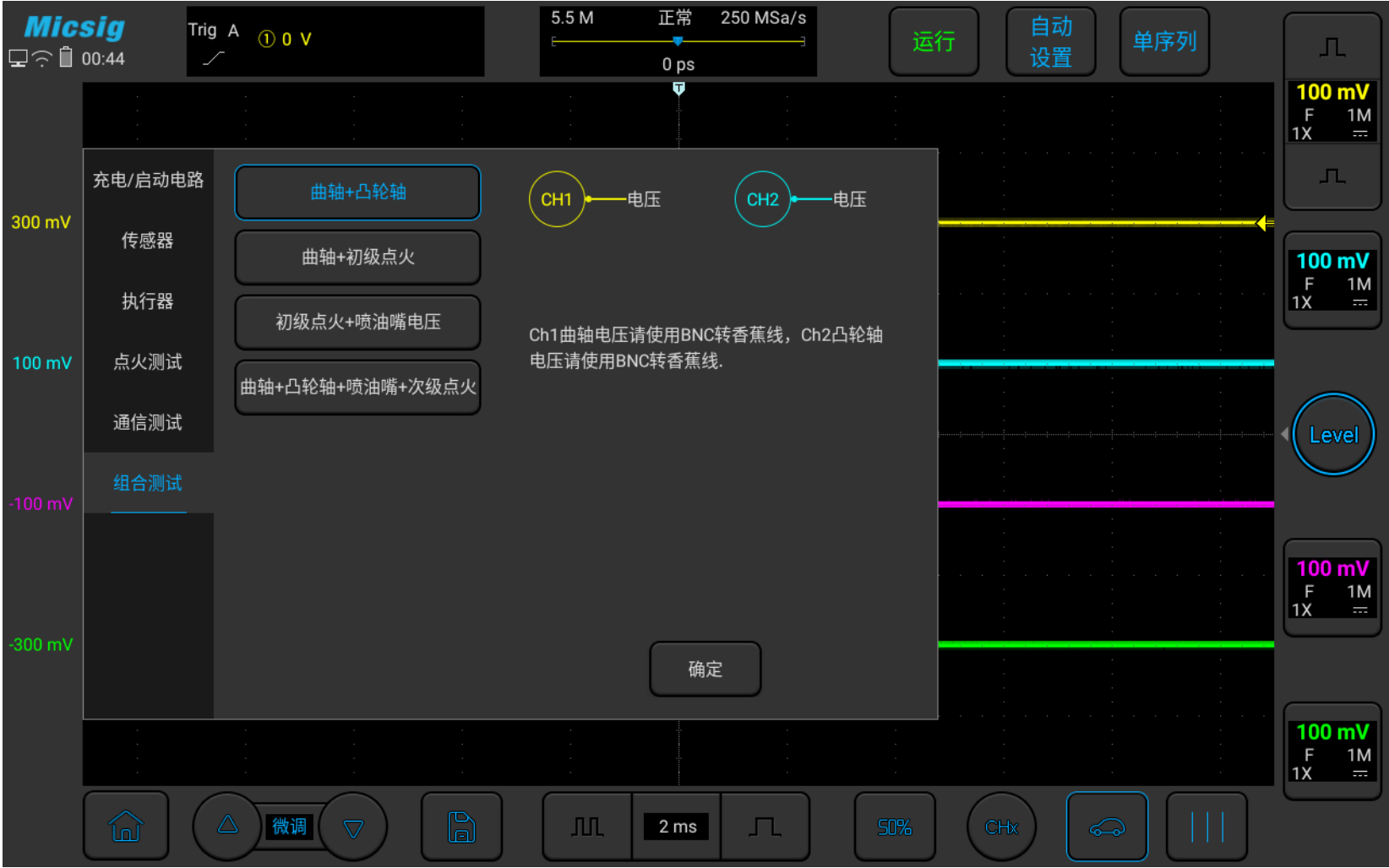
图3-55 曲轴+凸轮轴组合测试
