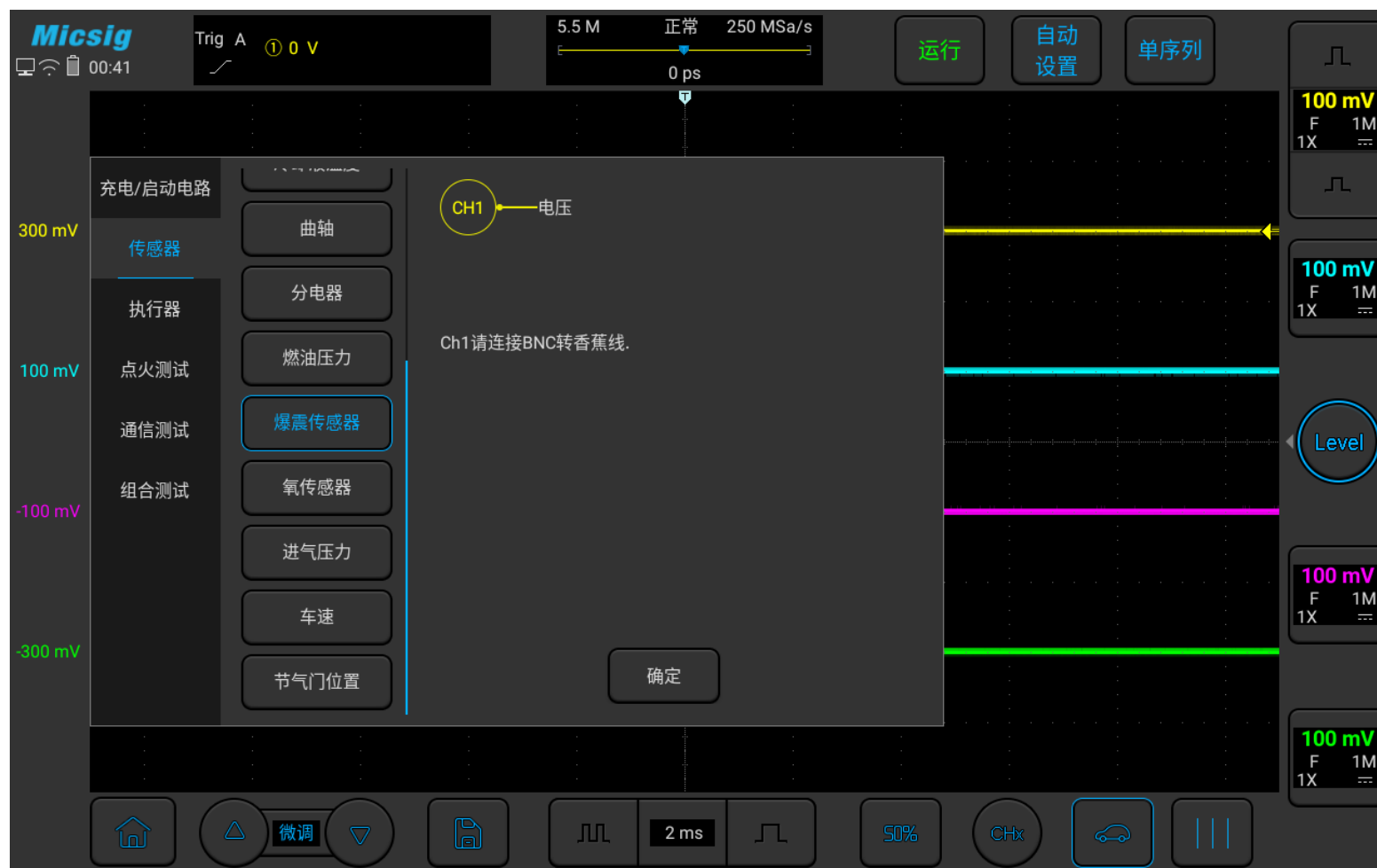
图3-21 爆震传感器测试
