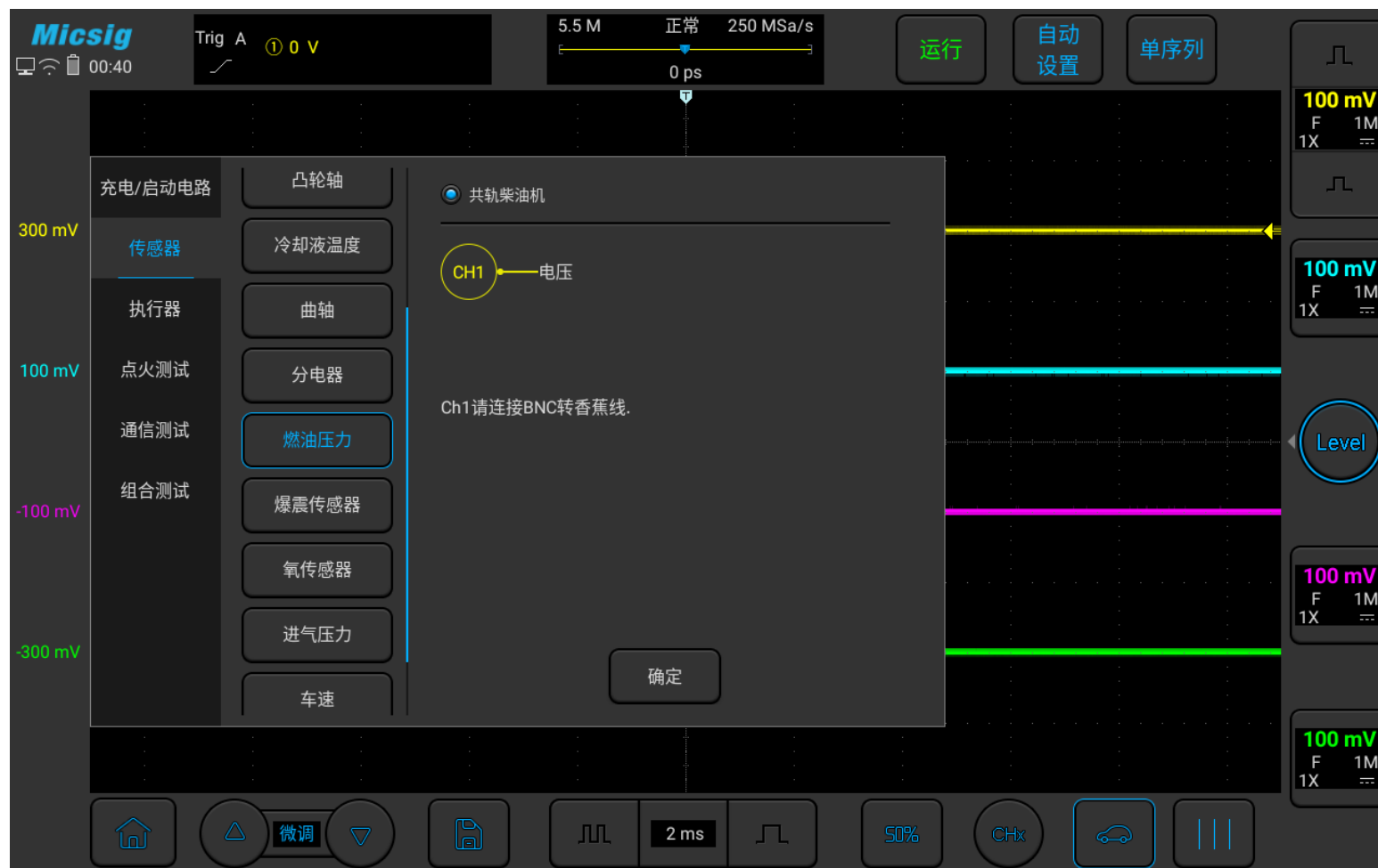
图3-20 燃油压力传感器测试
