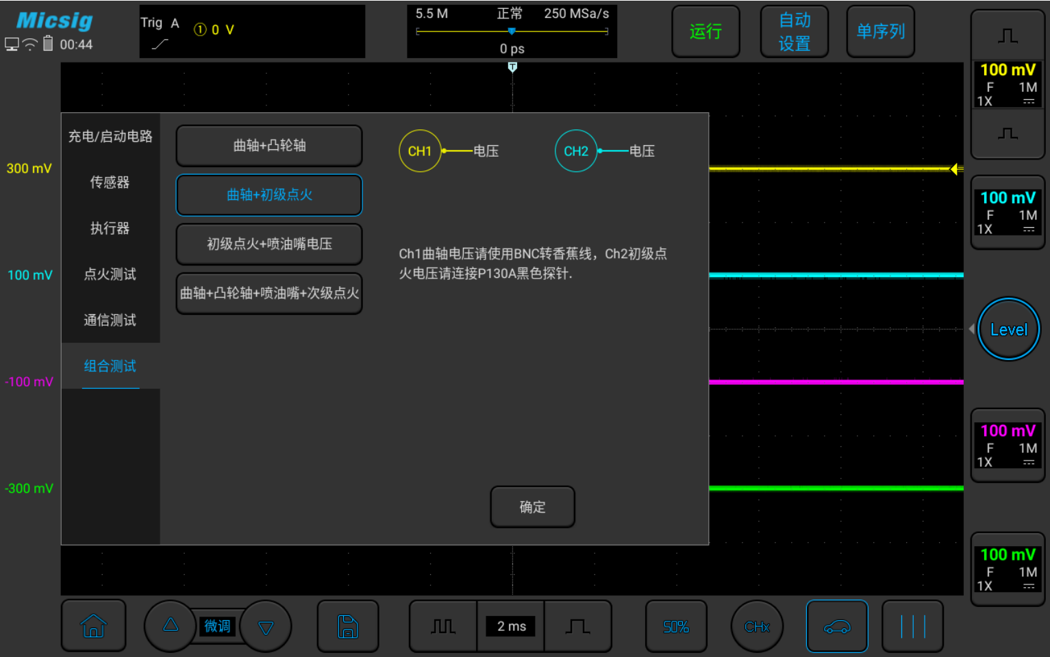
图3-56 曲轴+初级点火组合测试
