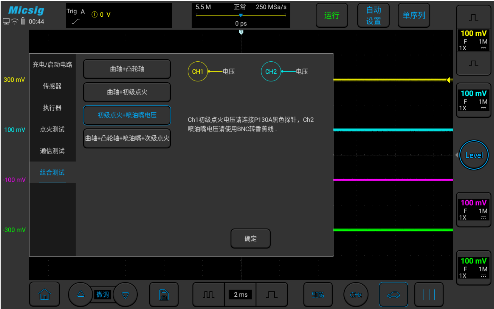
图3-57 初级点火+喷油嘴电压组合测试
