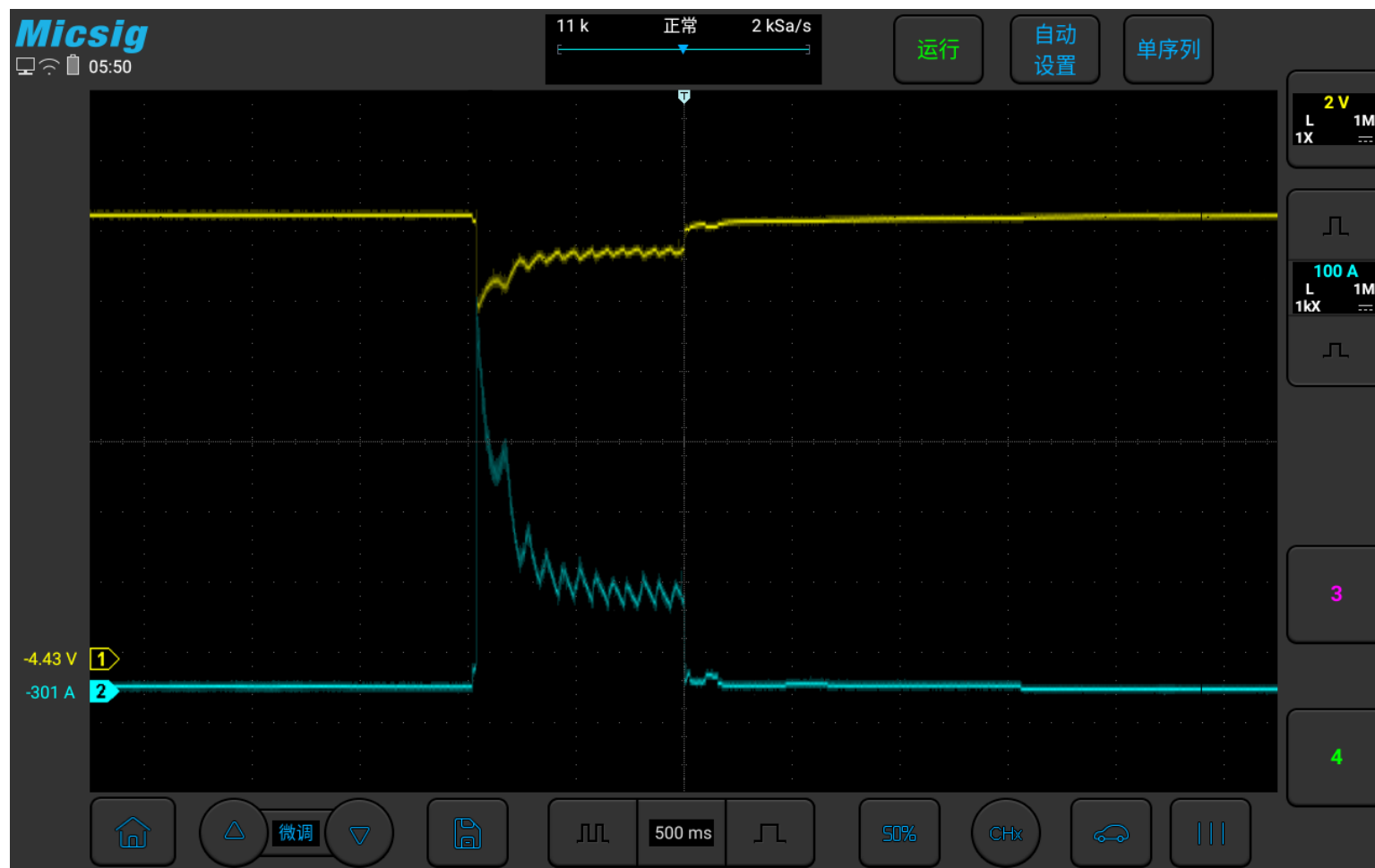
图3-7 启动电压与电流的实测图
