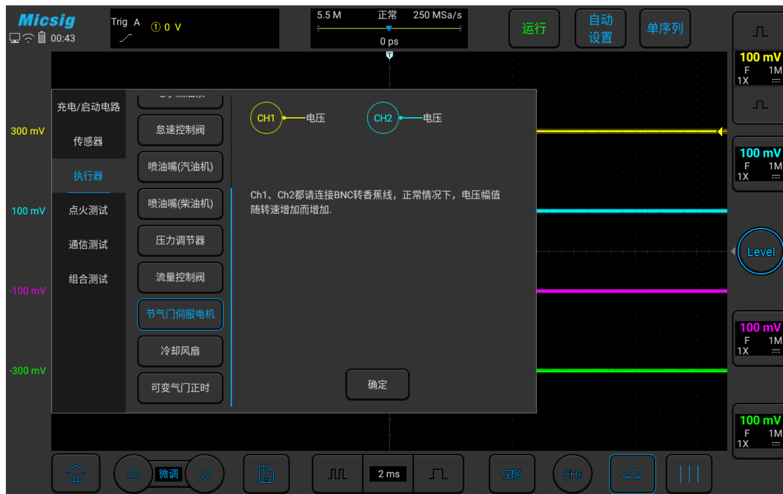
图3-39 节气门伺服电机测试
