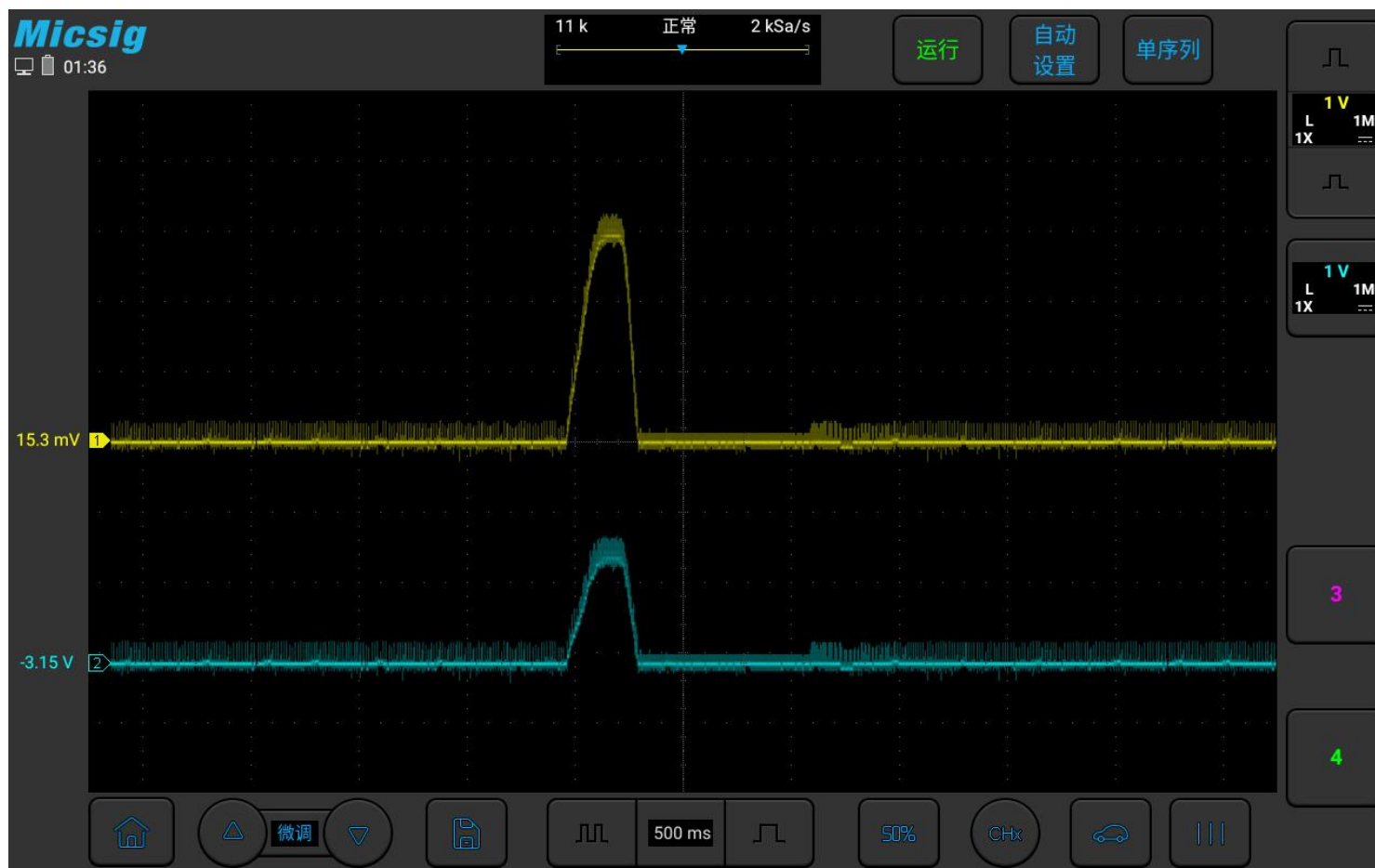
图3-12 油门踏板传感器的实测图
