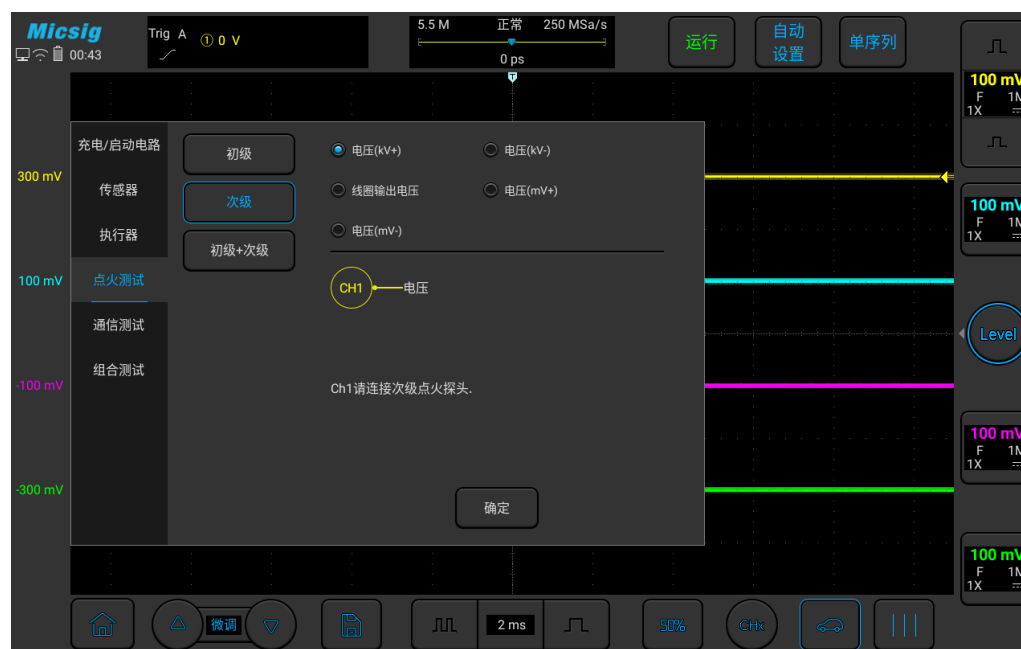
图3-46 次级点火测试
