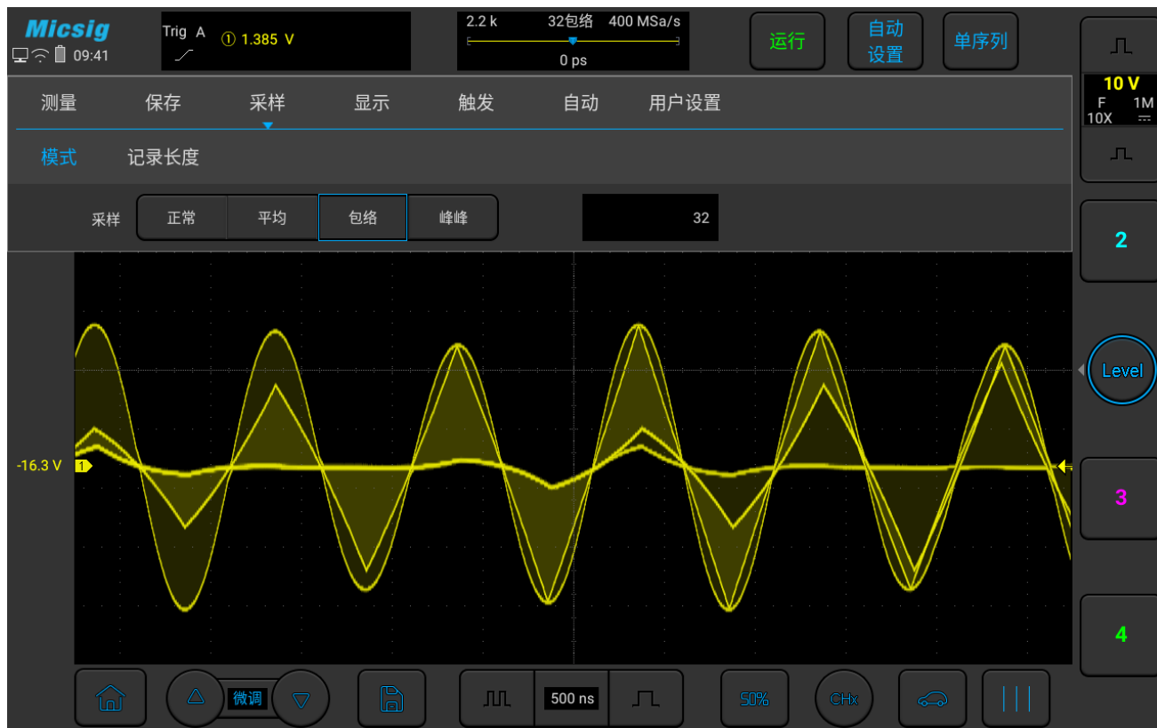
图11-8 包络采样模式（32）下的调幅信号
