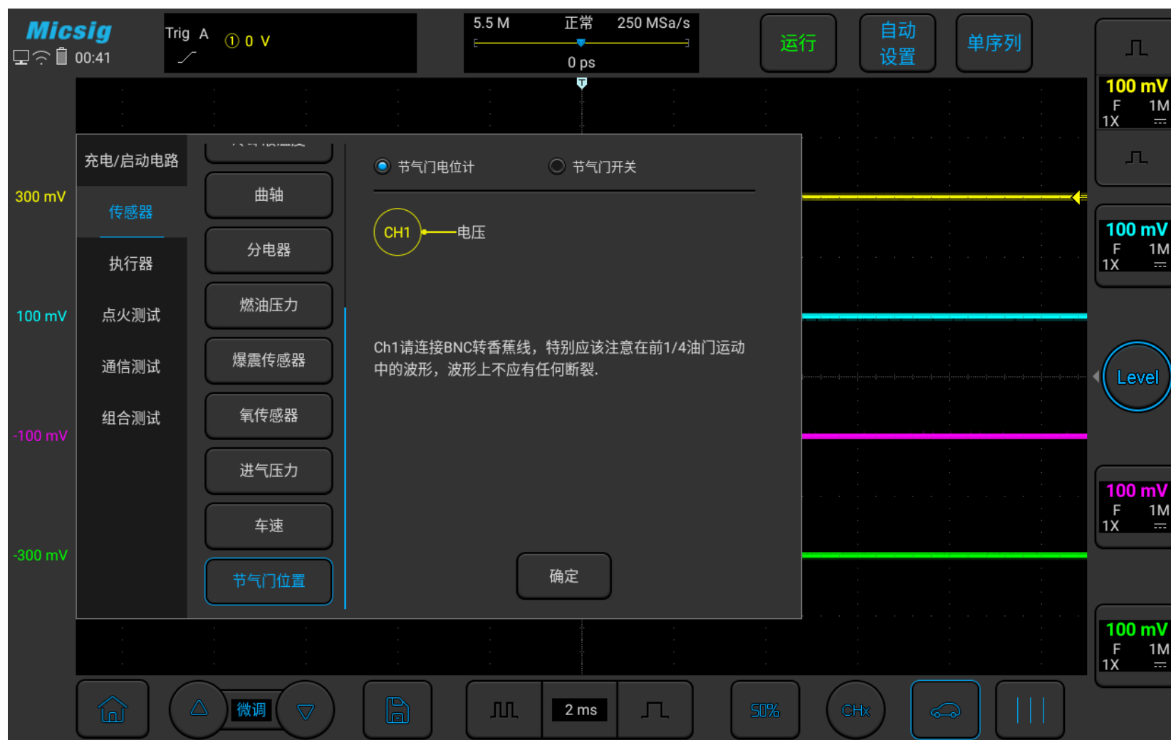
图3-27 节气门位置传感器测试
