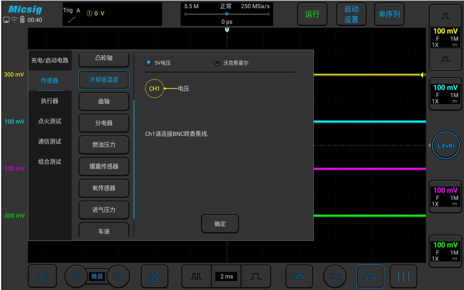
图3-16 冷却液温度传感器测试
