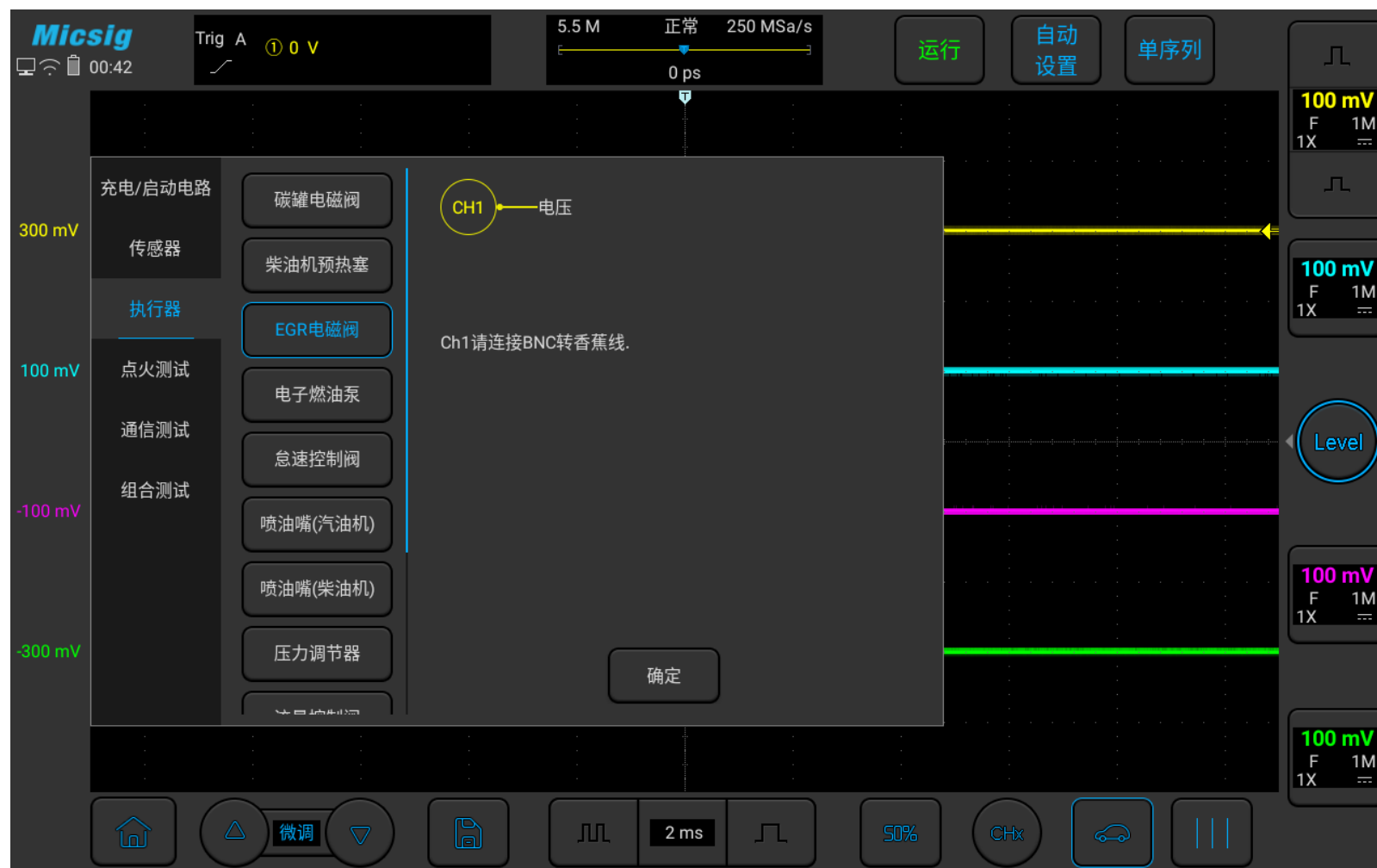
图3-32 EGR 电磁阀测试
