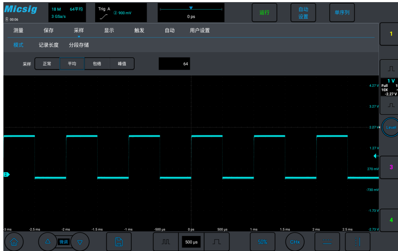
图10-7 选择平均采样模式后的波形，平均数 64
