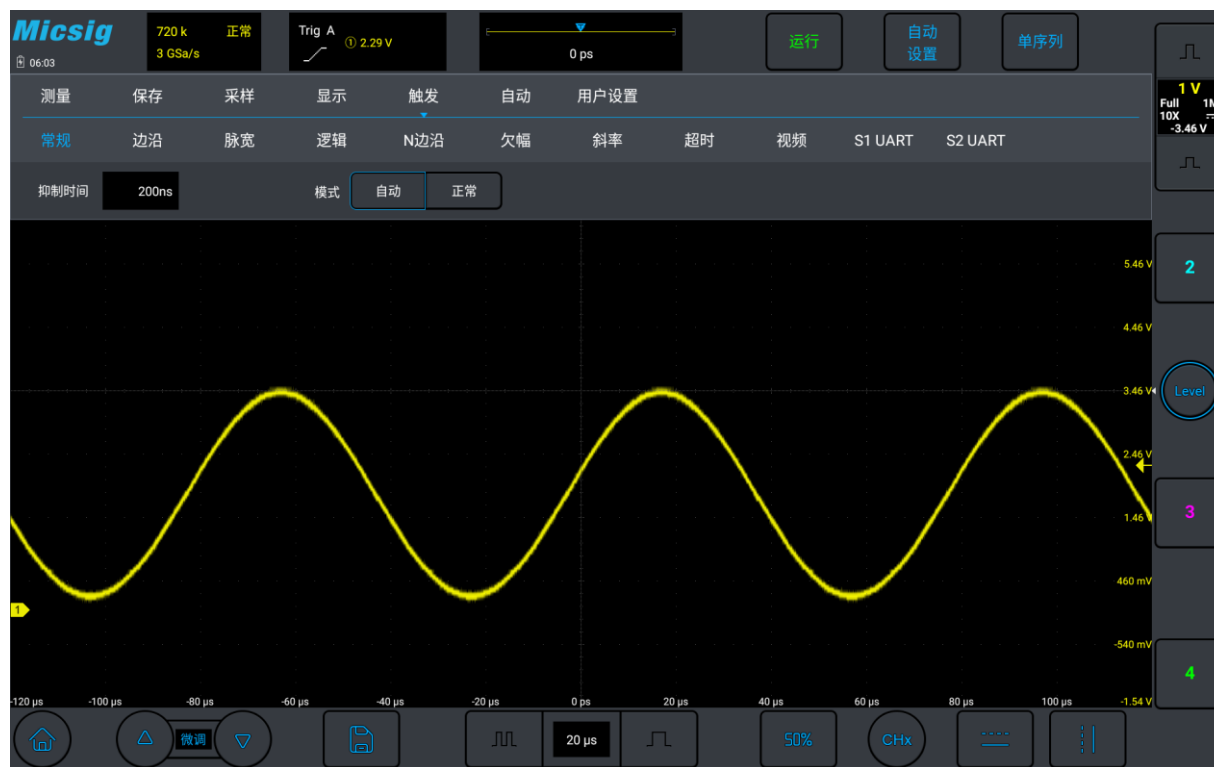
图5-5 示波器触发模式设置
