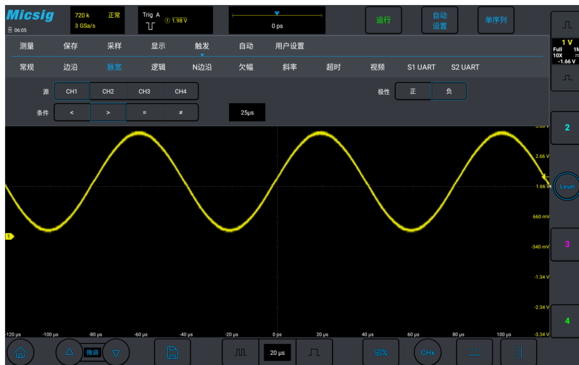
图5-15 负极性脉冲电平翻转
