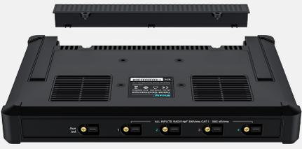
▶ ETO 系列内置大容量电池，满足实验室及外出两种测试场景需求。独家电源锁设计，防止误开机，携带运输更安心。
