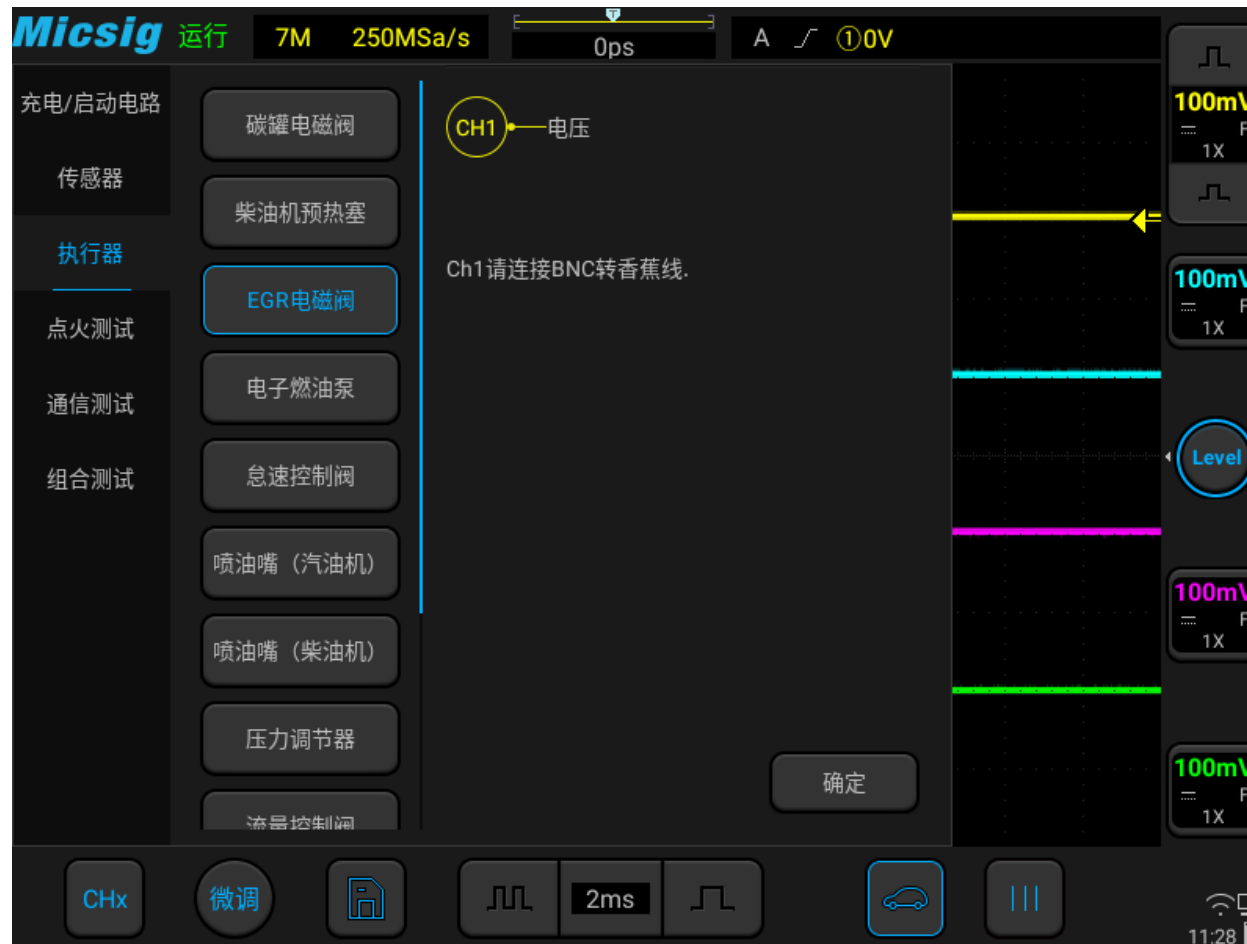
图3-32 EGR 电磁阀测试
