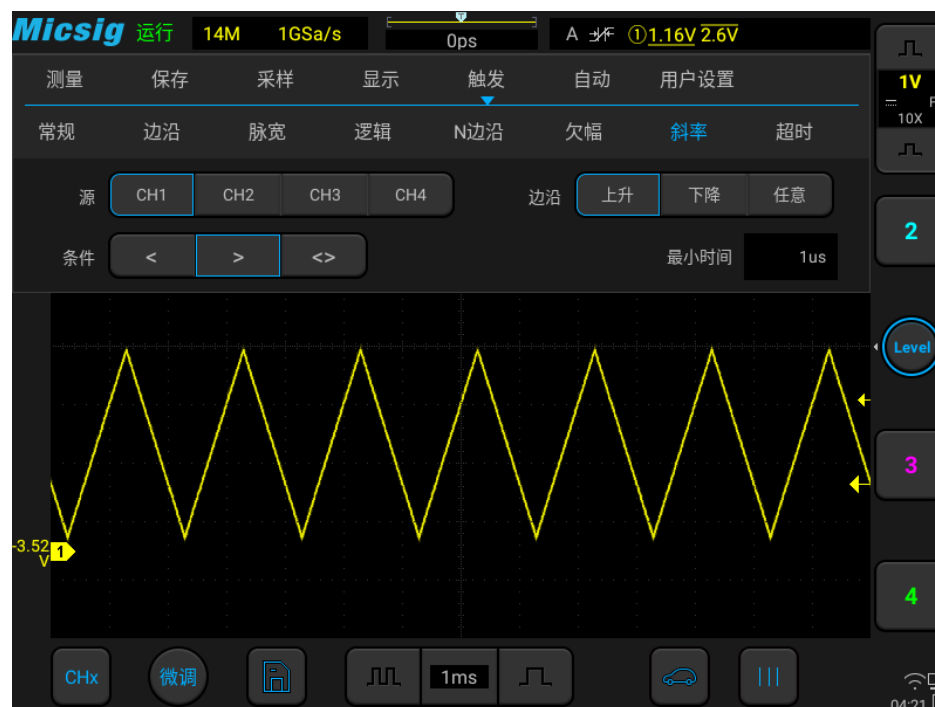
图7-27 斜率触发设置菜单
