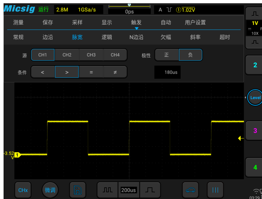
图7-15 负极性脉冲电平翻转
