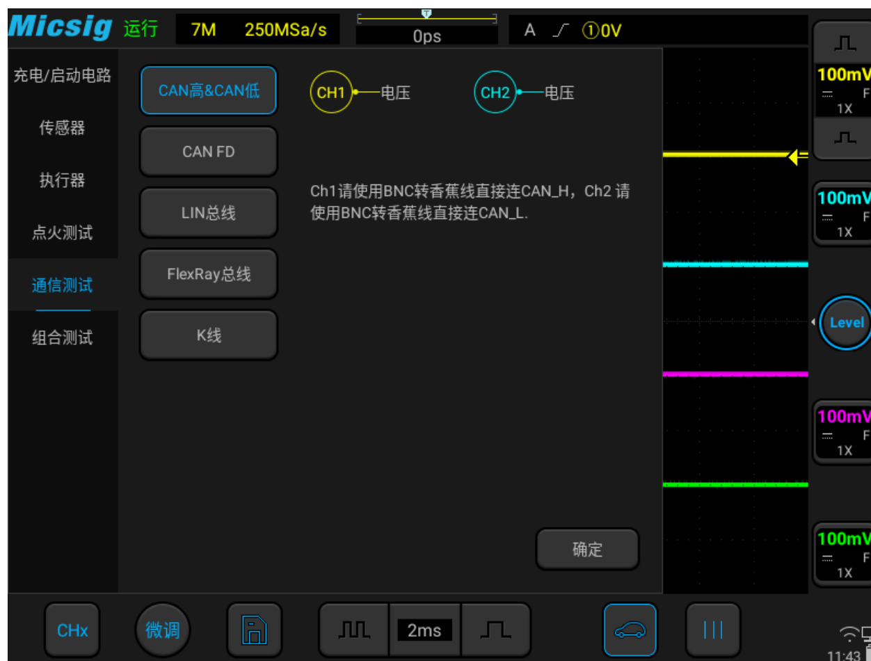
图3-49 CAN 总线测试
