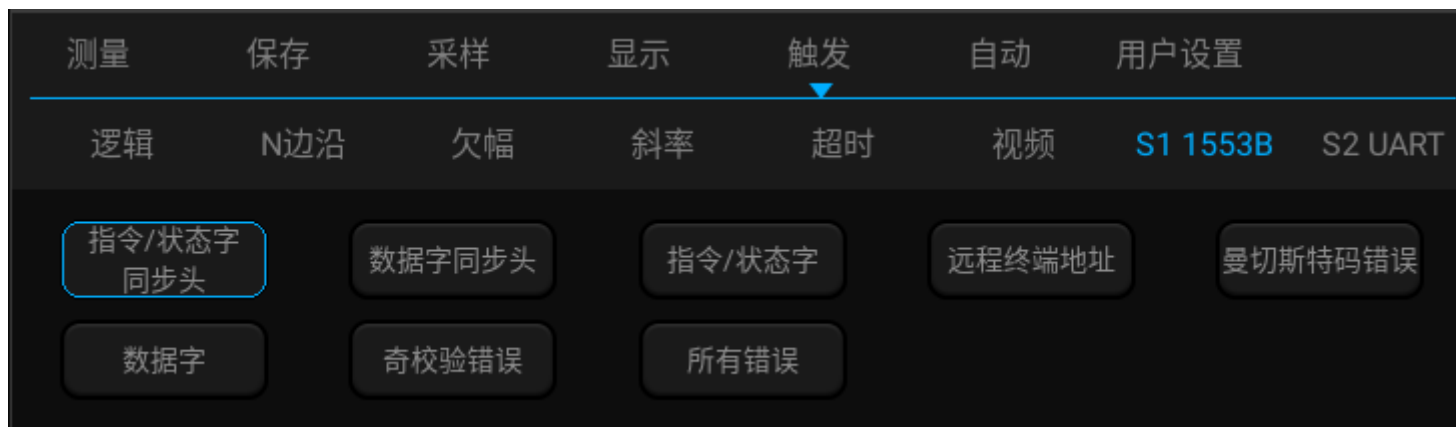
图13-31 1553B 触发方式配置菜单
