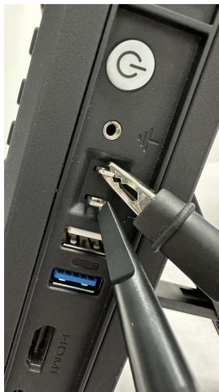
图2-13 探头连接方式
