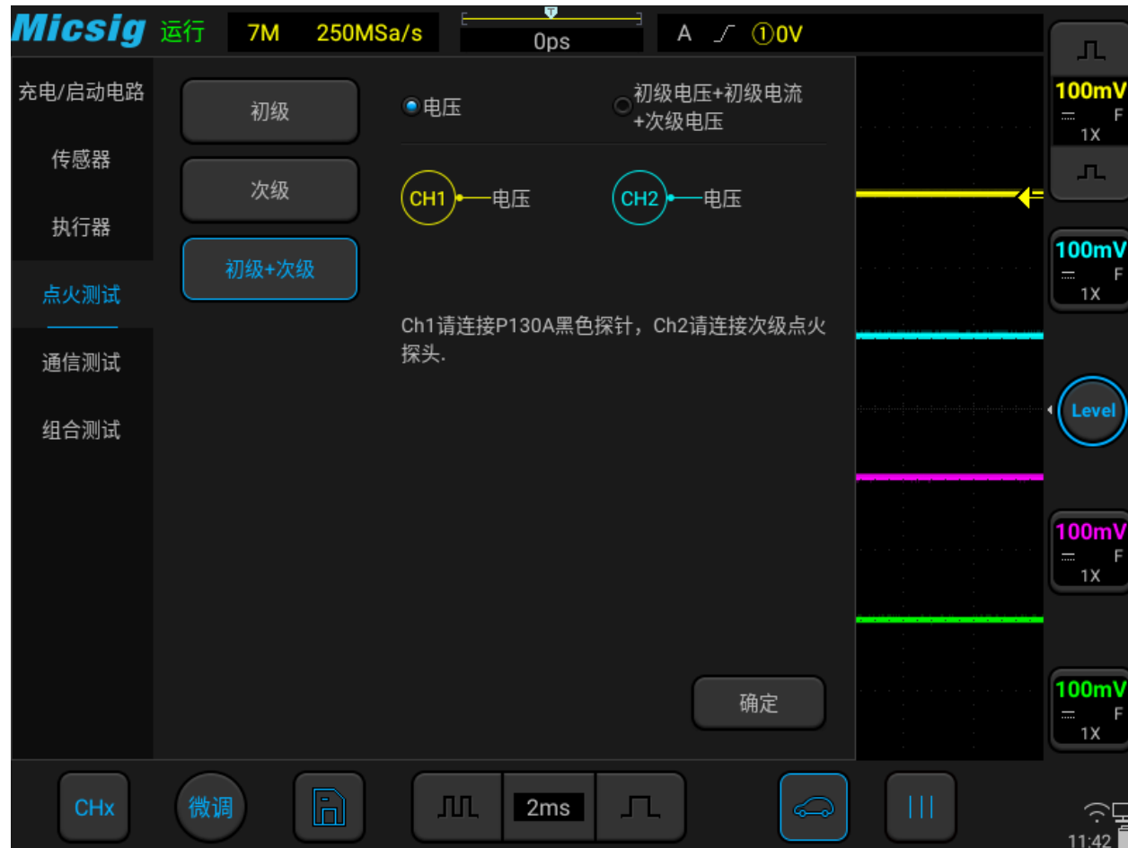
图3-47 初级+次级点火测试
