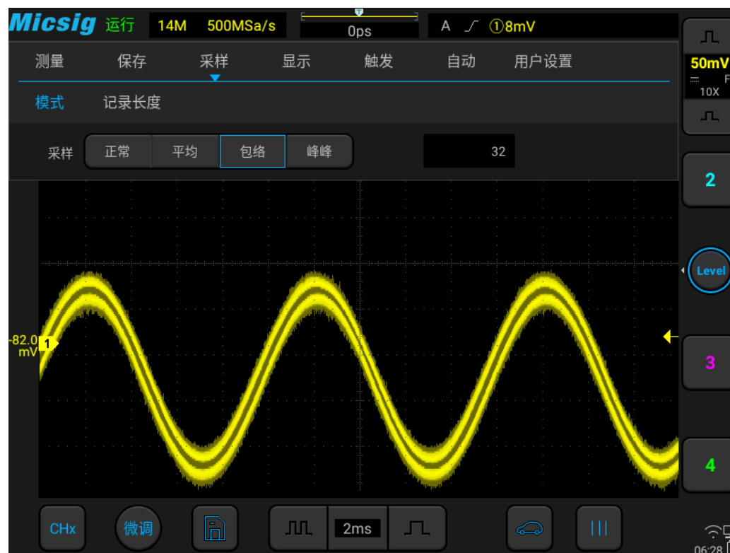
图12-8 包络采样模式（32）下的调幅信号
