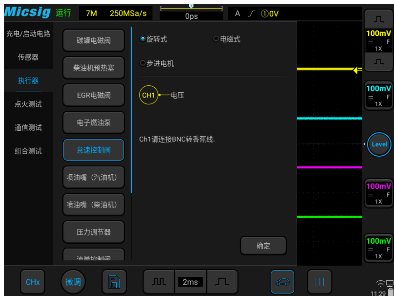
图3-34 怠速控制阀测试
