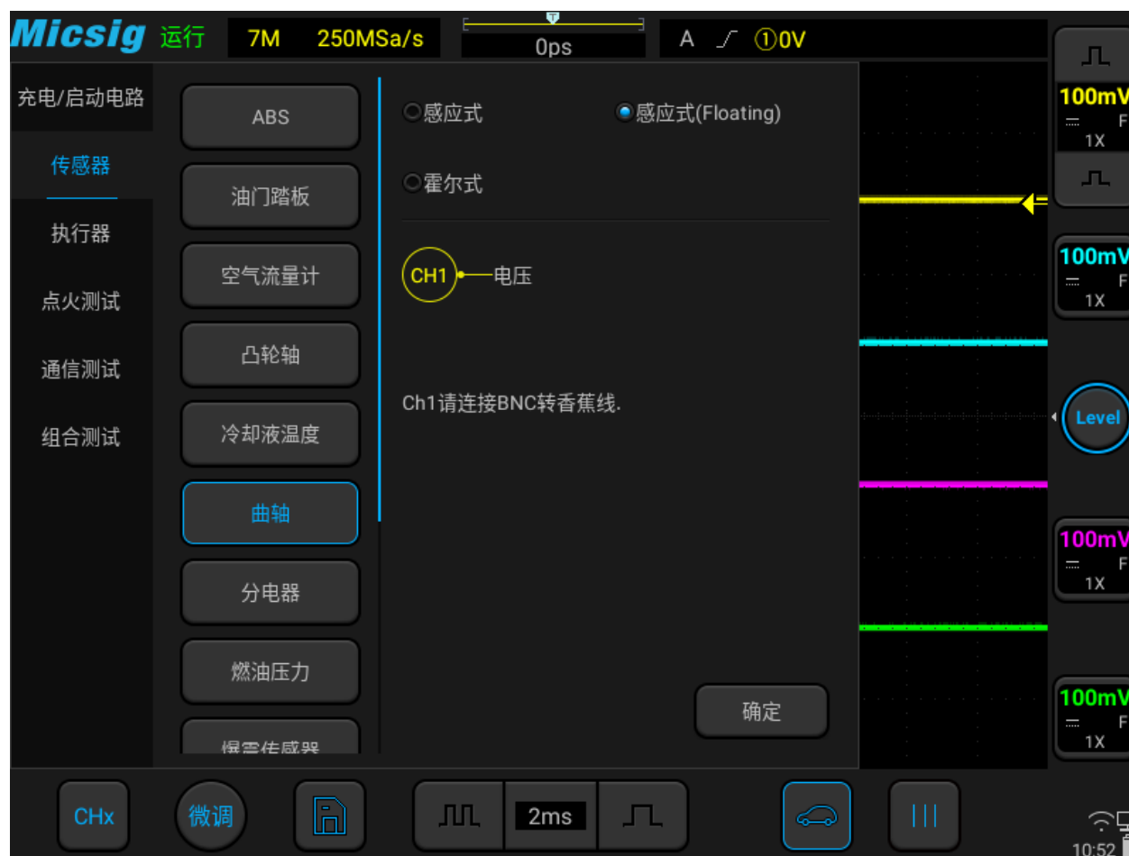
图3-17 曲轴位置传感器测试
