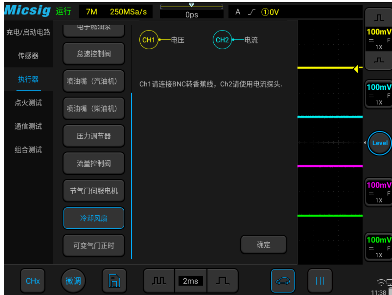
图3-40 冷却风扇测试
