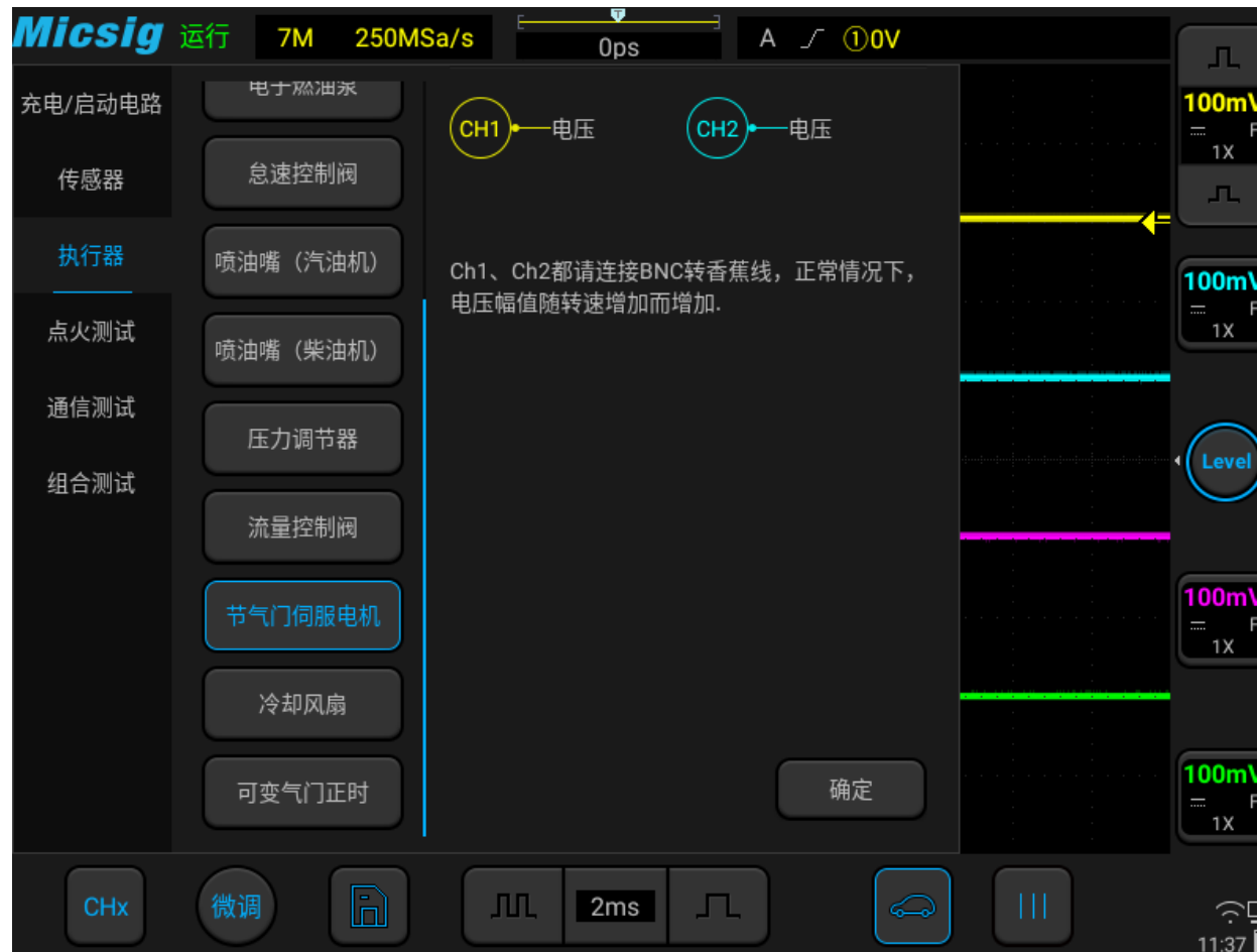
图3-39 节气门伺服电机测试
