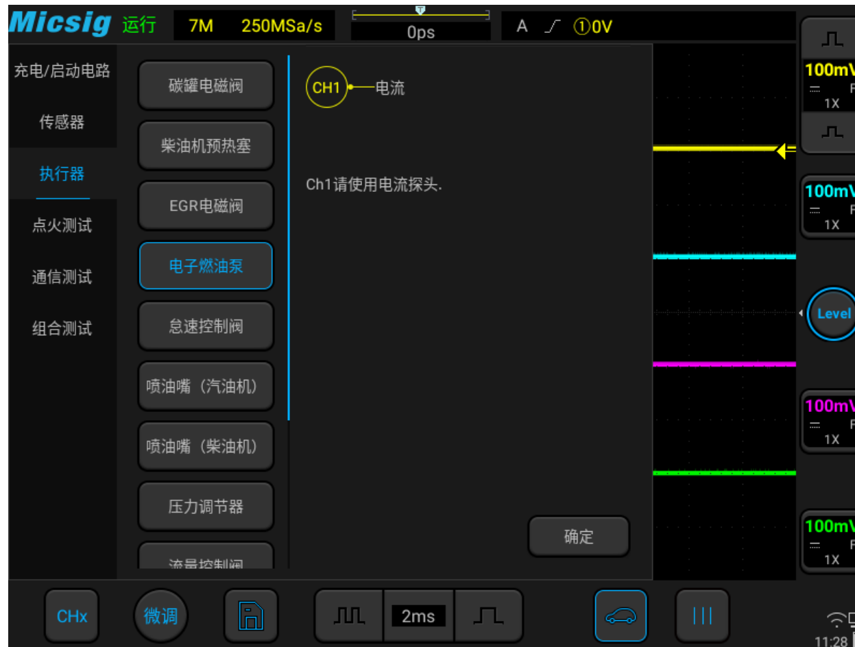
图3-33 电子燃油泵测试
