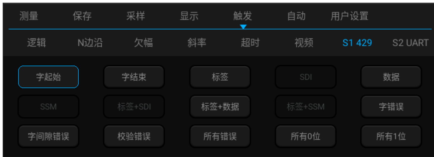
图13-27 ARINC429 触发方式配置菜单
