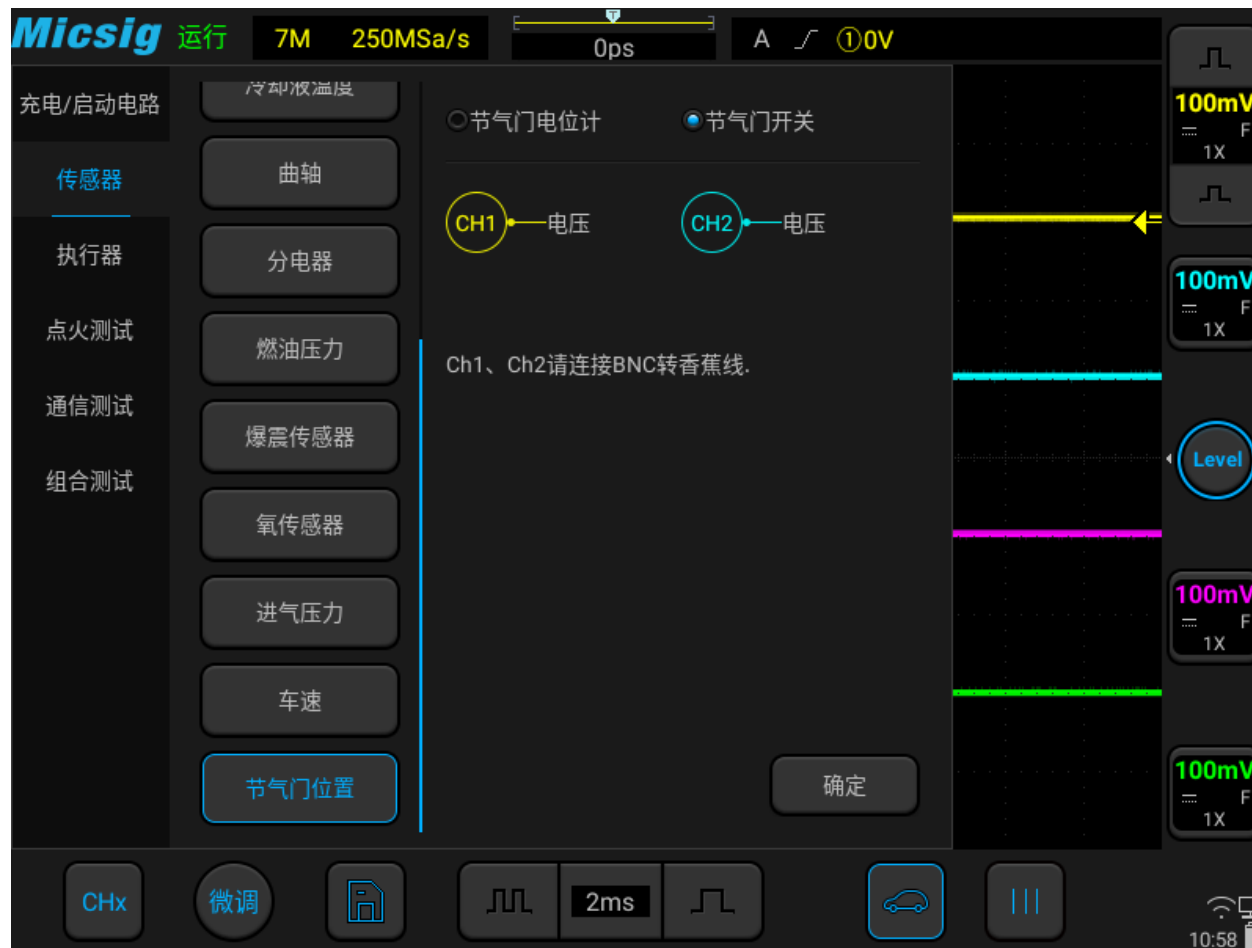
图3-27 节气门位置传感器测试
