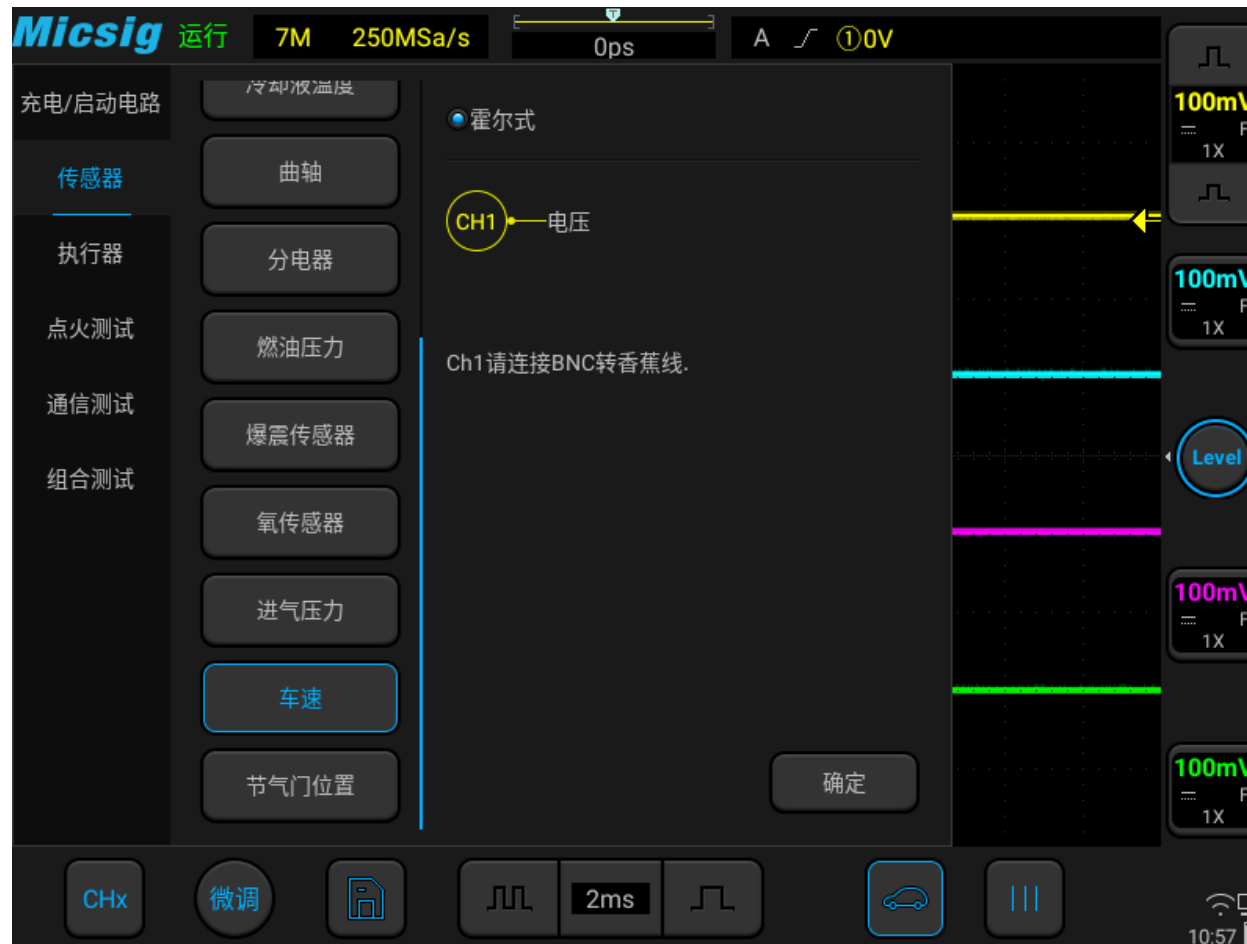
图3-26 车速传感器测试
