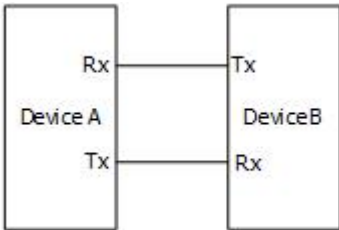
图 3.2 RS232 串行总线示意图
