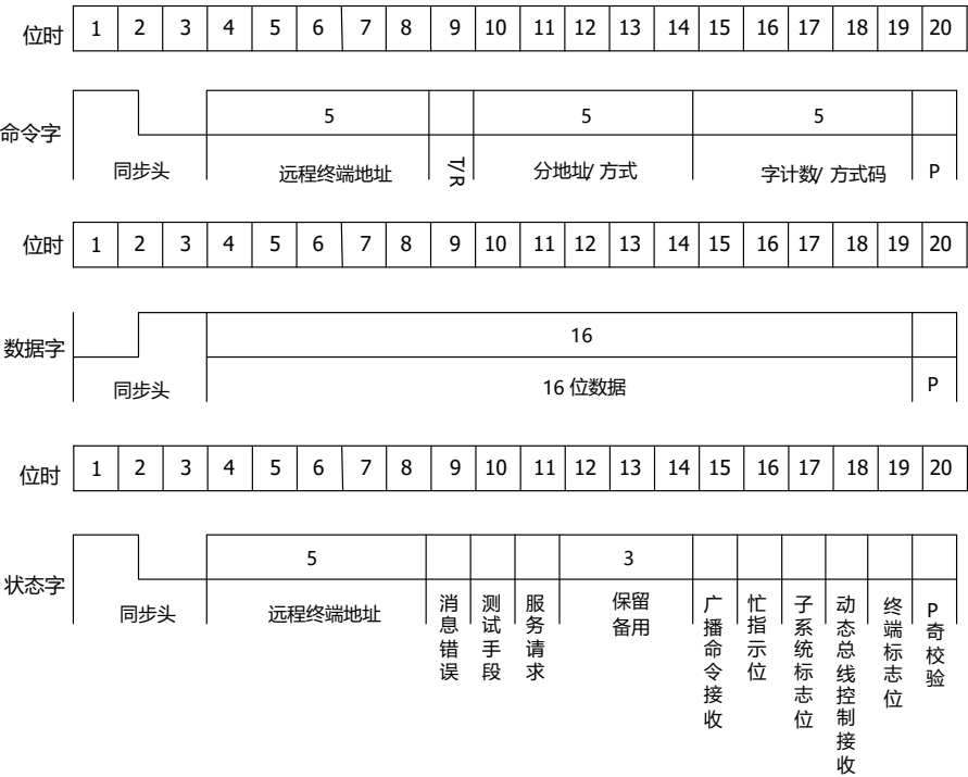
图 3.14 1553B 总线命令字、数据字和状态字格式图
