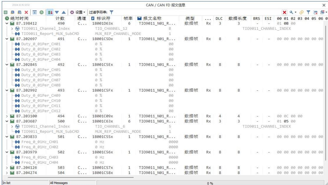
同时在 CAN 数据库中可看到 TIO9011 所有的控制报文，选择并发送报文即可控制模块执行对应的功能。
