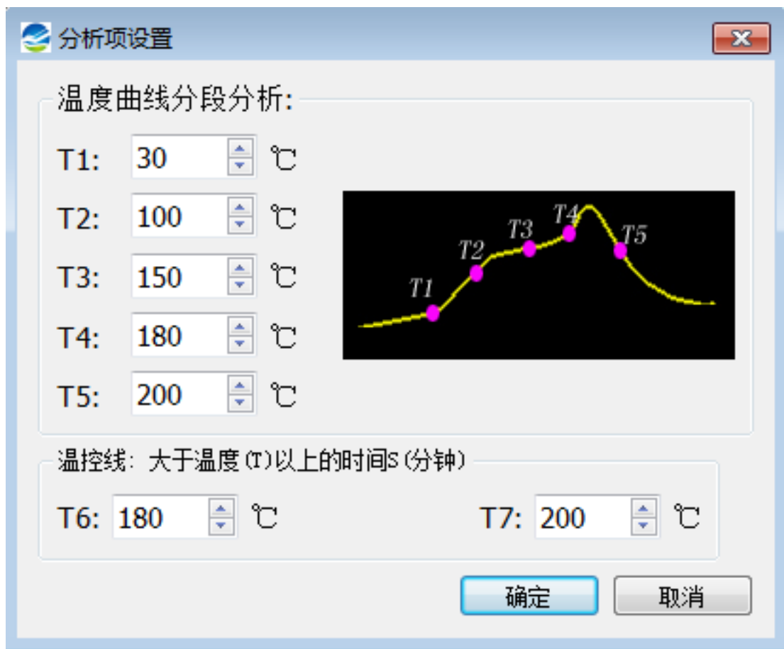
图 12 打开分析项设置进行工艺设置
