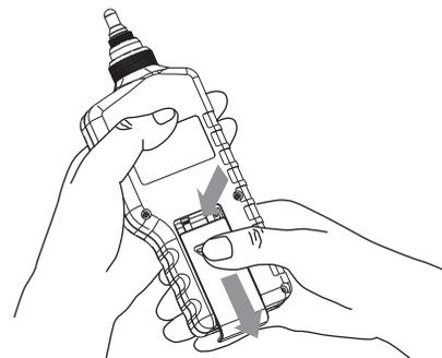
▶ 正确的将9V电池放入电池舱内, 注意电池的极性, 然后合上电池门, 如下图:
