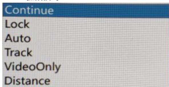
· **连续模式:** 扣下扳机进行测速，只有在放开扳机的时候如果速度为超速才进行保存。
