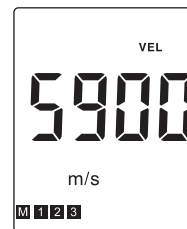
上次关机前使用的声速 及已占用厚度存储单元号
