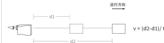
测速模式可以对径向运动物体的速度进行测量，平行移动的物体由于其距离测距仪的距离没有发生变化，无法测出其速度。
