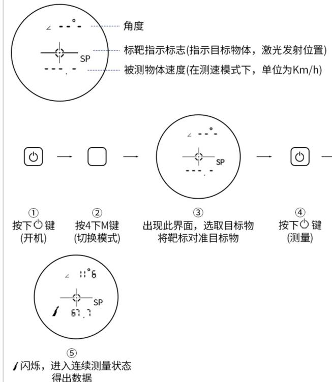
6、高尔夫距离修正模式 (将测距值和坡度值(<math>\pm 20^\circ</math>)带入到高尔夫飞行弹道算法中, 为用户提供建议击打距离)
