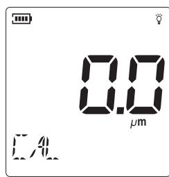
出现显示值0.0 μm，此时对铁基进行零点校准。
