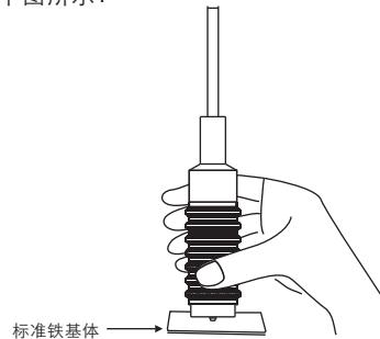
c. 在不提 探头的情况下，按“ $\blacktriangle$ ”和“ $\blacktriangledown$ ”键修正读数后，校准已完成，可以开始测量了。
