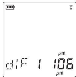
▷ 将探头置于被测件，轻压探头进行测量，提探头并响一声“嘀”，LCD屏幕显示前一个值与当前值之差值的绝对值，LCD屏幕显示如下图所示：
