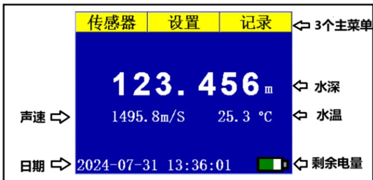
测量水深：传感器到水底反射面的距离；
