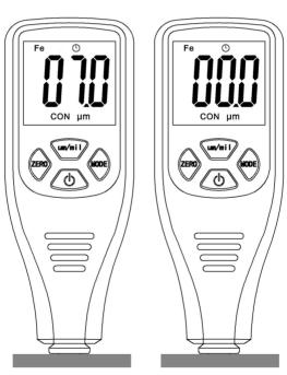
**50um** 点校准:方法与零点校准相同,唯一区别是将 50um 标准厚度片放在基片与探头之间;以下作一个简单图示:
