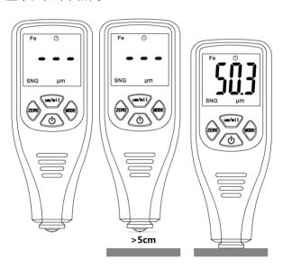
快速连续测量模式:按 MODE 键显示 CON,探头垂直接触并轻压初测试件,屏幕显示数值会随着探头移动而快速更新,如下图所示:(注:CON显示时,请勿随意按 ZERO 键,此时 ZERO 键用于用户自定义校准,若不慎按错,请恢复出厂设置。):
