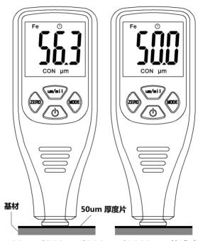
**100um/250um/500um/1000um** 校准方法与 50um 点校准方法相同,只需换成对应的厚度片就可以了。
