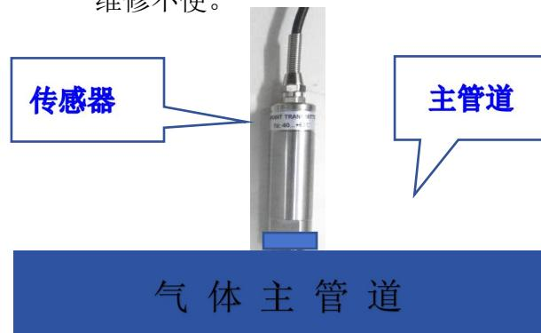
方法二：管道间接测量法——将气体从主管道引出到采样室，探头接在采样室上测量，出气口排空。
