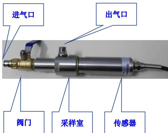
方法三：大环境测量——将传感器直接置于手套箱、干燥房、空气等环境直接进行测量。
