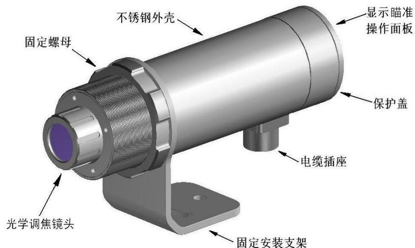
BC800 系列在线式比色红外测温仪是一款具有目视光学瞄准，高精度、高重复性、防水、防尘的测温仪。它采用先进的 DSP 技术和智能数据处理技术，可同时 LED 显示温度、RS485 输出温度数据、4-20mA 电流输出温度数据和继电器智能报警输出。仪器具有测量精确、智能化、速度快、抗干扰强、尺寸小等突出优点，可测量运动目标、小目标或视场不能被完全覆盖的目标，尤其适用于在烟雾、水蒸气和灰尘等恶劣环境下传统单色不能准确测量的目标。
