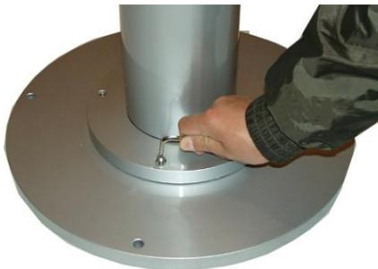
2.4 将望远镜放置到立柱(或电器箱)上方，顺时针旋转钥匙取下面板，取备附件包裹内剩余的四个内六角螺钉，将望远镜连接到立柱上。
