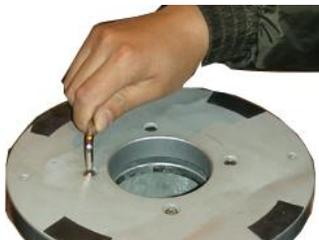
2.3 将小底盘及立柱用 2.1 卸下的内六角螺钉连接在大底盘上
