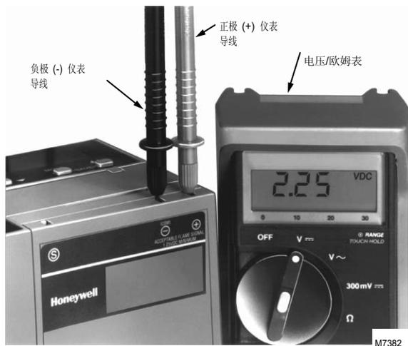
图11. 测量7800系列控制器火焰信号电压值
