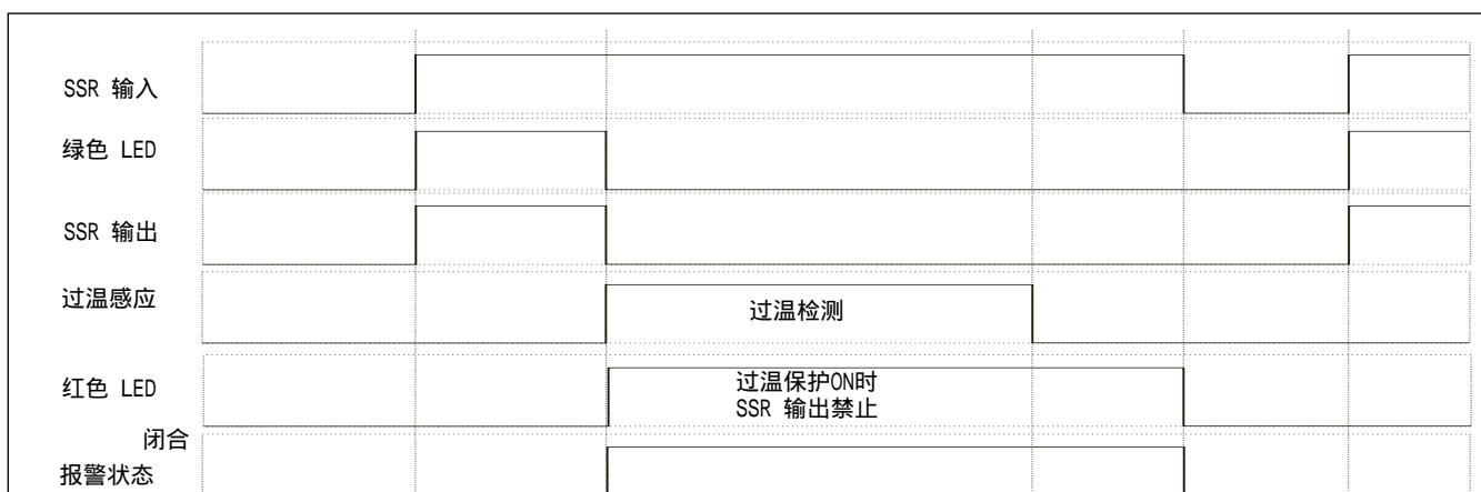
\*过温状况解除后，SSR可以通过断开控制输入20ms后再重新复位，并且之后输出将再次恢复至接通状态。
