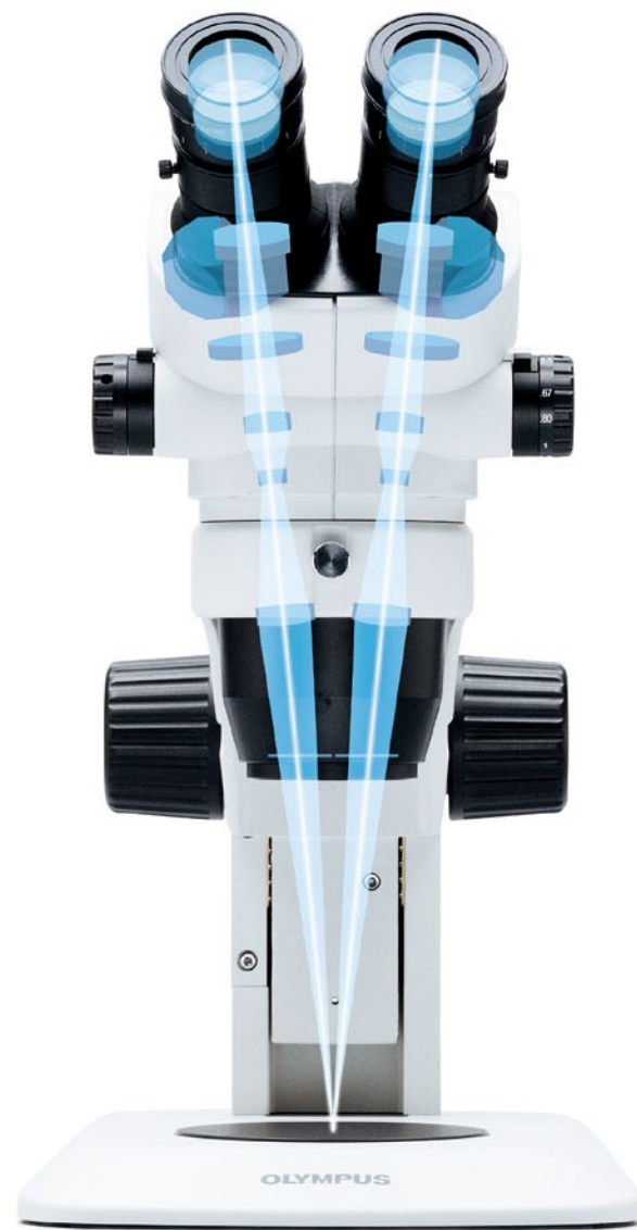
格里诺光学系统有两个向内倾斜的变焦光路。这可以使显微镜的结构设计的更加紧凑，同时还能保持高性能。
