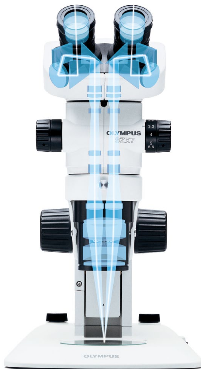
伽利略光学系统采用两个 (左/右) 独立平行的变焦光路, 通过同一个物镜获得焦点。该系统既能够实现高光学性能也能够实现功能的模块化。
