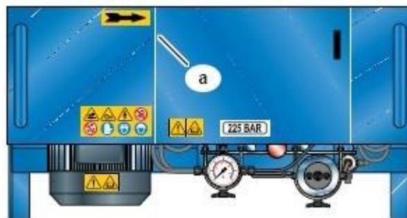
如果转向错误，请按右图调动两条电线接线。
