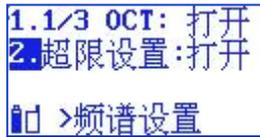
在测量界面将光标移到显示模式处，按“参数加/减”键进入超限设置界面，如下图所示：
