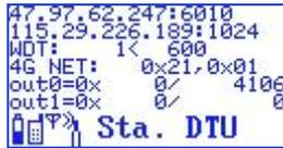
第一行为联接 0 的主机 IP 地址及端口号，用户可以在 DTU 设置界面修改。
