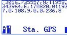
需要将仪器放置在露天的户外，并在设置中打开了 GPS 读取功能，收到 GPS 信号时，界面上会显示出来。
