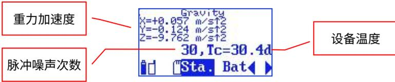
图 6-8 脉冲噪声次数和设备温度
