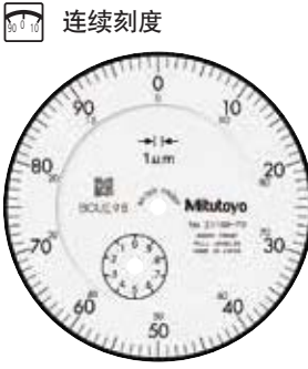
连续刻度 分度值: 0.001 mm 测量范围: 1 mm 防水型 双倍刻度间距型 防震型 宝石轴承型
