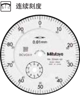
连续刻度 分度值: 0.01 mm 测量范围: 10 mm 防水型 上死点缓冲型 全量程范围示值误差13μm
