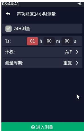
图 6-4-5-1 声功能区 24 小时测量设置
