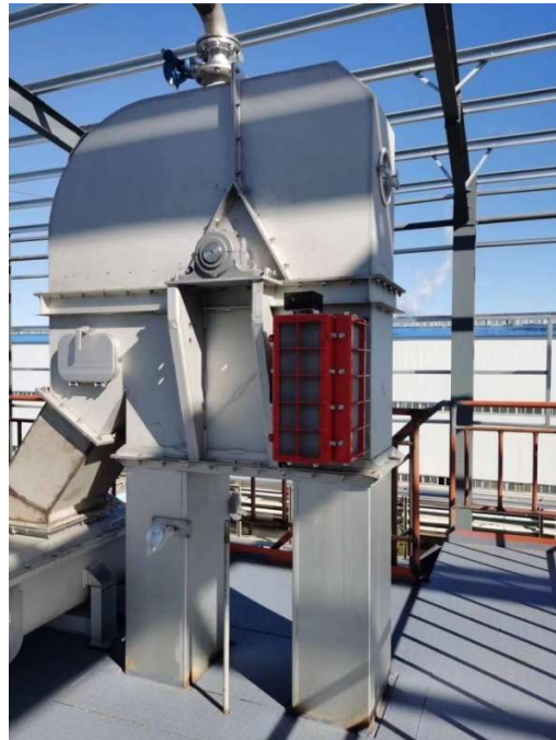
某生物科技公司无火焰泄爆及抑爆系统现场安装示意图
