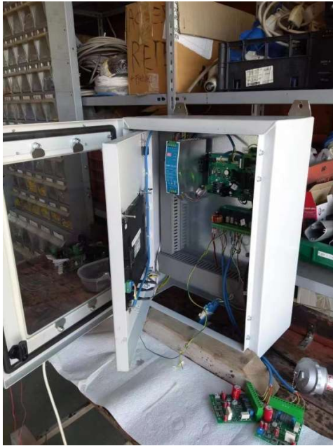
意大利CONTROL LOGIC火花探测器 workshop车间系统组装调试
