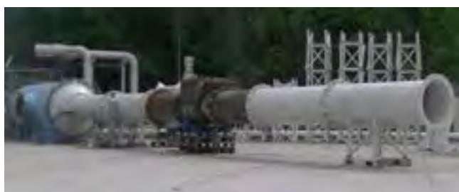
INERIS机构 测试隔爆阀
