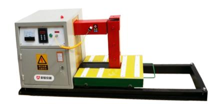
适合轴承内径 mm 160-1000 最大轴承外径 mm 1300 最大轴承宽度 mm
