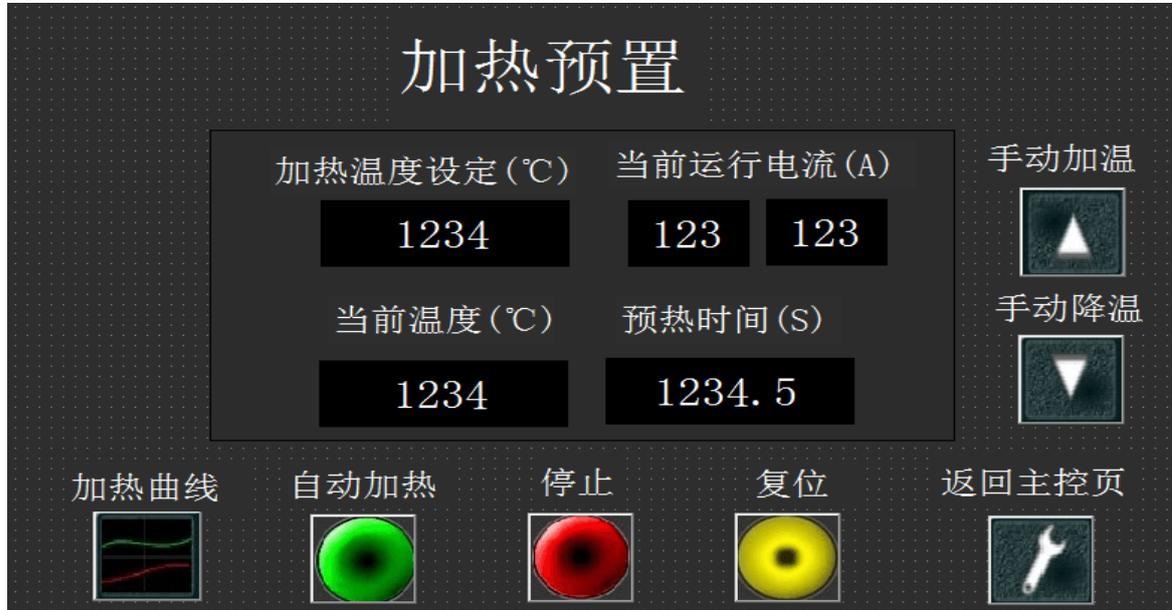
B、点击 加热温度设定 下黑框中 显字 部位，系统会弹出 键盘，输入 试验目标温度 或 设定 电流（分 手动 和 自动） 点击 ENT 确定 及 关闭 键盘
