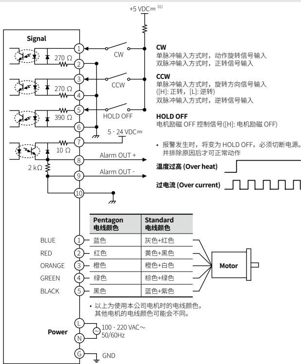
01) 当外部的信号输入超过 +5 VDC 时，请在外部连接电阻。
