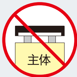
主体悬空安装
