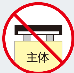
主体 主体悬空安装
