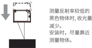
测量反射率较低黑色物体时，收光量减少。安装时，尽量靠近测量物体。
