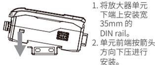
1. 将放大器单元下端上安装宽 35mm 的 DIN rail。
