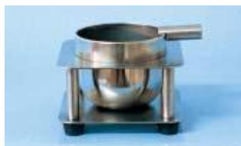
测量金属丝和小部件的电解杯
