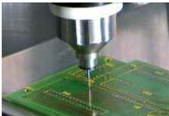
这种方法只除去几乎看不到的一小块面积，而不影响基体。库仑法确保结果可靠，准确。GalvanoTest使用简便，操作者不需要专业技能只需在实际测量发生之前很少的培训。库仑原理是测量单镀层或多镀层的唯一低成本方法。例如铁上依次电镀铜再镀镍再镀铬。
